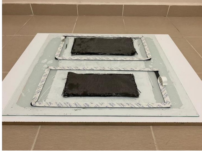
Şekil 3.14: Kumaşların kalıba yatırılması
