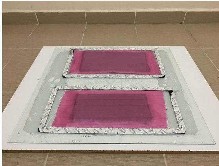
Şekil 3.15: Soyma kumaşının takviye kumaşların üzerine yerleştirilmesi
