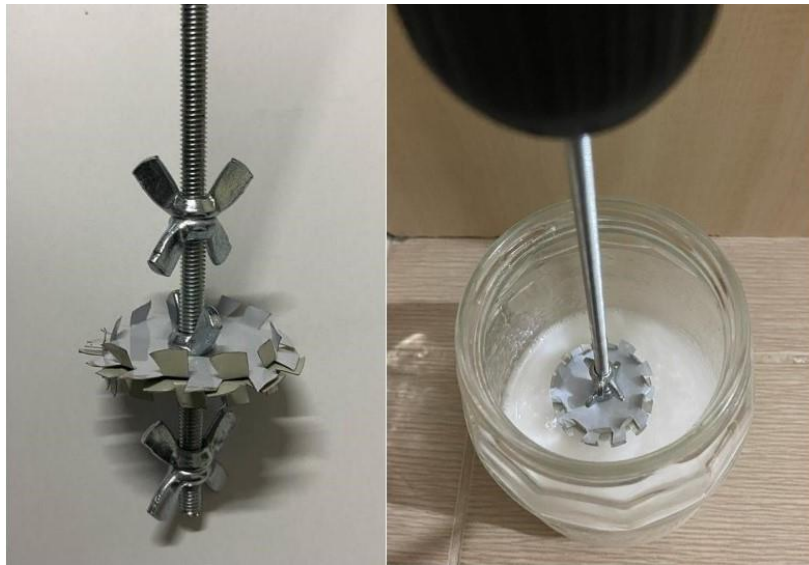
Şekil 3.6: SiO 2 ile reçinenin mekanik karıştırılması
