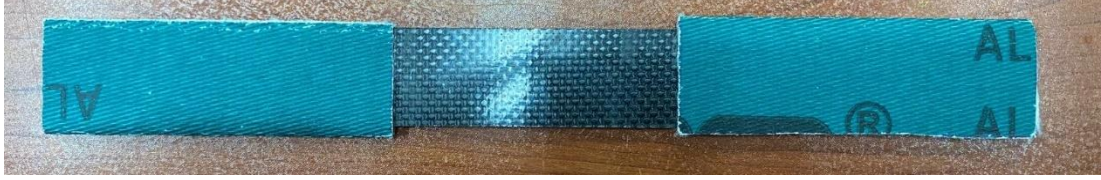
Şekil 3.27: Zımparanın çekme deneyi numunelerine sarılması
