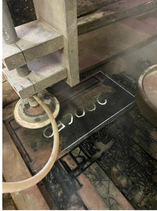
Şekil 3.23: Kompozit levhaların su jeti ile kesimi
