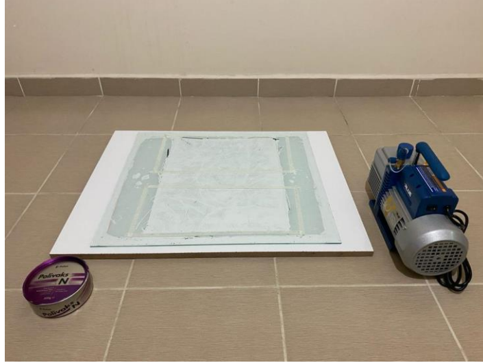
Şekil 3.12: Kalıp ayırıcı vaks işleminin yapılması
