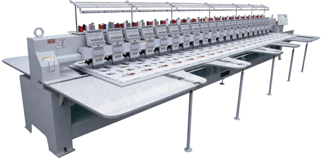
Şekil 3.4: Sanayi tipi bilgisayarlı nakış makinesi
