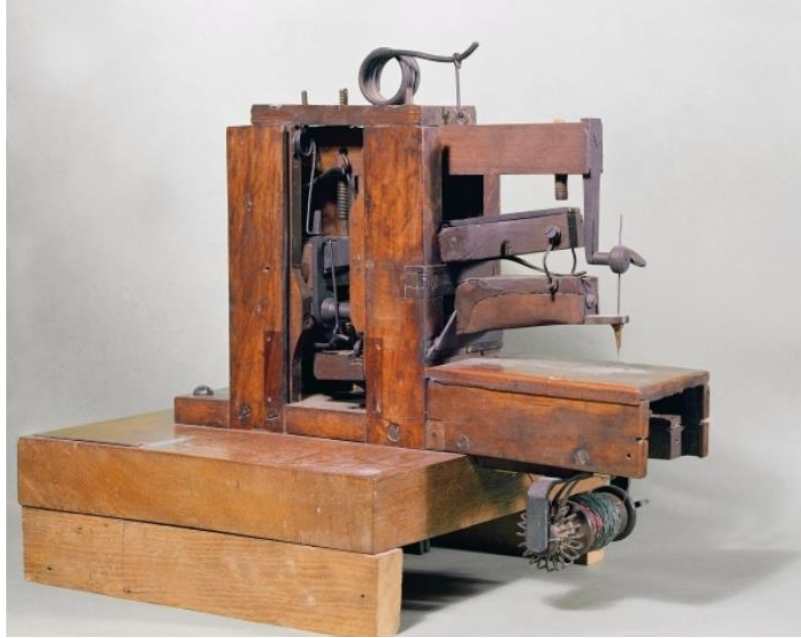
Şekil 3.5: B. Thimonnier ve Clair P. Thimonnier'in 1830'da dikiş makinesi
