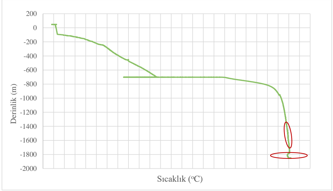
Şekil 4.7: 8 no.lu jeotermal alandaki belirsiz kuyudan alınan statik sıcaklık derinlik loğu.
