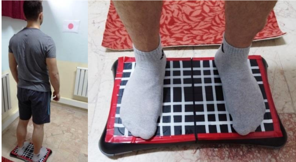
Şekil 3.5 Çift ayak üzerinde WDP denge değerlendirilmesi ve ayakların yerleşimi
