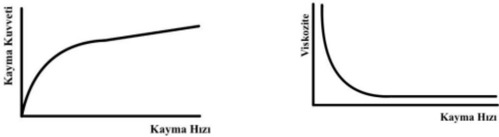
Şekil 6. Non-Newtonian sıvılar için kayma kuvvetinin kayma hızı ve viskozite ile ilişkisi [63]
