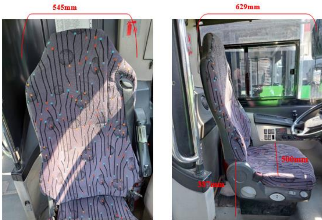
Şekil 2.4. Şoför koltuğunun önden ve yandan görünüşü ve ölçüleri.
