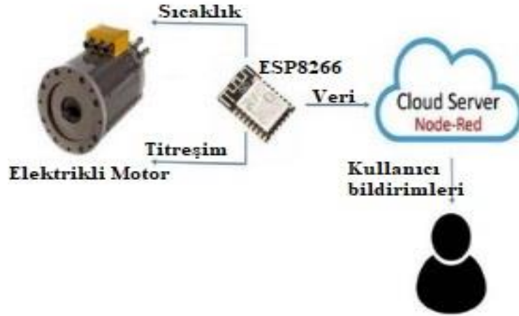
Şekil 6.4: Elektrikli motorun takip sistemi (Sidik ve diğ. 2020)
