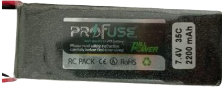
Şekil 4.9: Araçta kullanılan güç kaynağı
