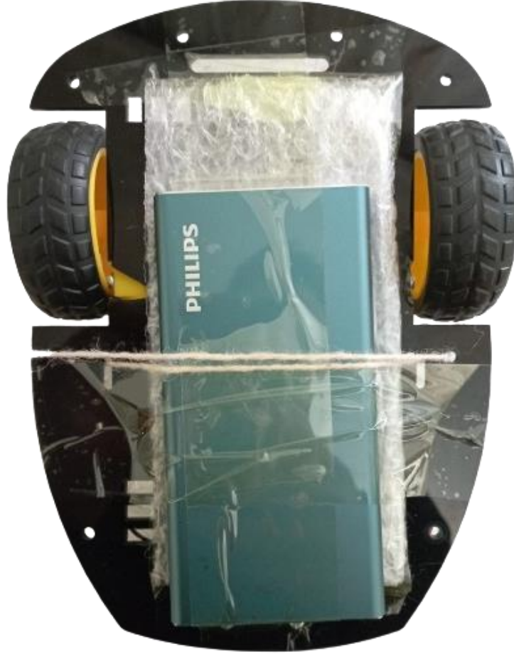
Şekil 4.13: Montajı yapılan otonom aracın ilk katı
