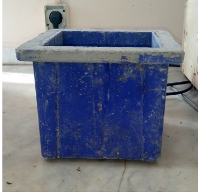
Şekil 4.4: Basınç testinde kullanılan beton küp numune kalıbı
