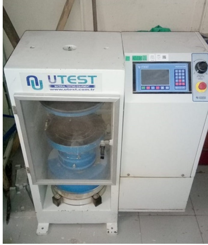
Şekil 4.9: Basınç dayanımı deneyinde kullanılan test cihazı
