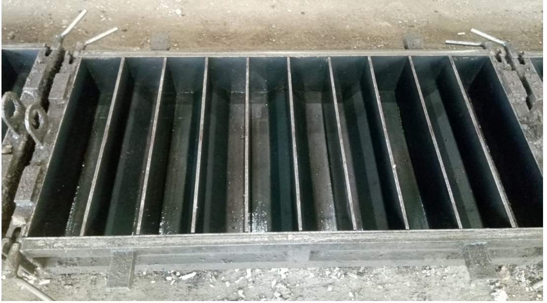
Şekil 4.5: Prekast beton bordür üretiminde kullanılan kalıp
