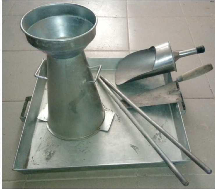
Şekil 4.8: Çökme (Slump) deneyinde kullanılan deney düzeneği
