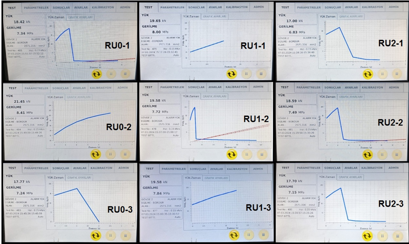
Şekil 5.5: RU0, RU1 ve RU2 numune grubu bordür eğilme dayanımı kırılma yükleri
