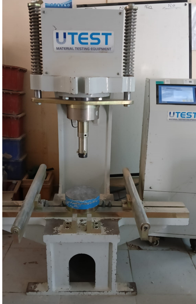
Şekil 4.10: Eğilme dayanımı deneyinde kullanılan test cihazı
