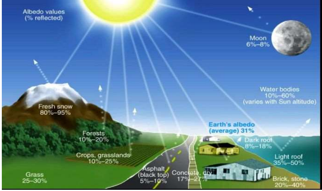
Şekil 4.1: Farklı zeminlerde albedo katsayısının gösterilmesi (Albedo Nedir?, 2024).
