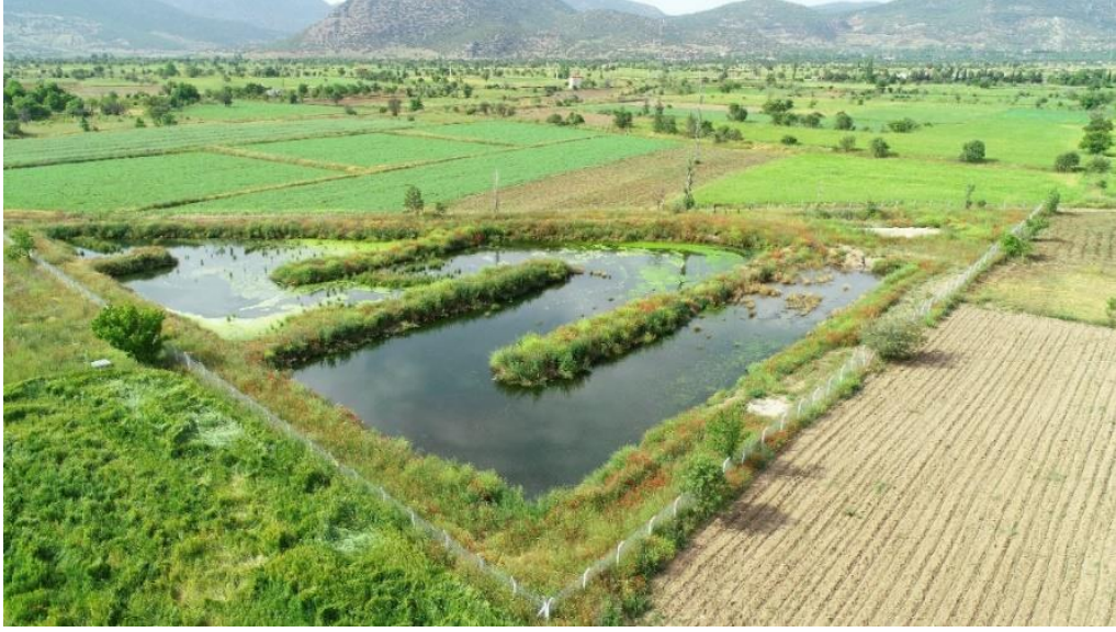
Şekil 6.33: Yazır serbest yüzeyle, üçgen parsel şeklini alan dolambaç akışlı YSA
