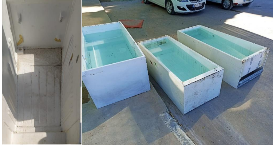
Şekil 5.10: Pilot deneme için kullanılacak çelik tankların yalıtım testleri
