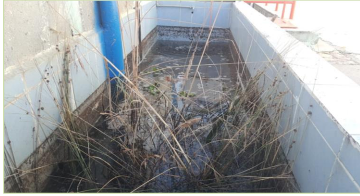
Şekil 5.7: Denizli Merkez AAT cilalama amaçlı SY YSA pilot tesisi, başarısız bitki dikimi
