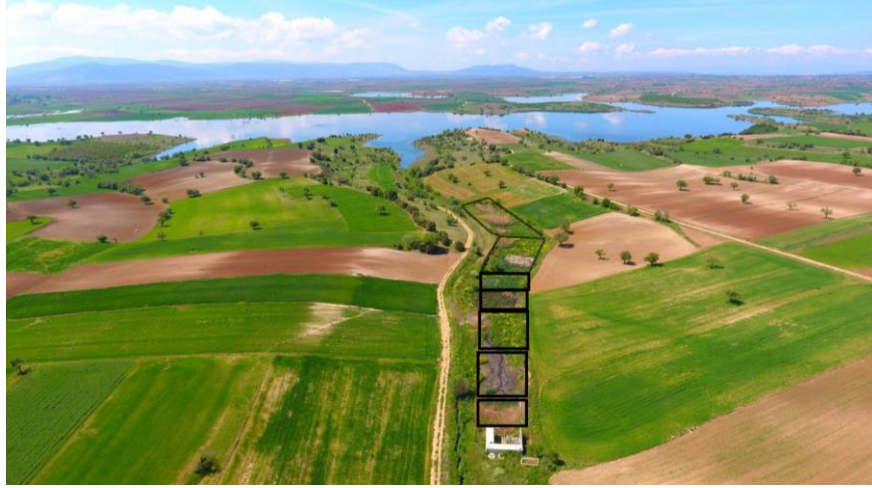
Şekil 5.25: Karahisar doğal arıtma tesisinin serbest yüzeyli ön çöktürme ve yatakları ile gölete erişim
