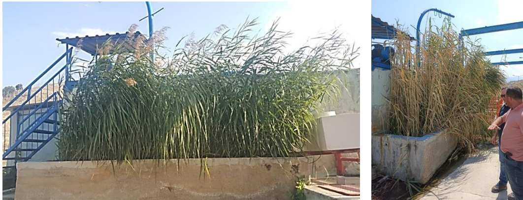
Şekil 5.8: Denizli Merkez AAT cilalama amaçlı SY YSA pilot tesisi, Phragmites australis bitkileri
