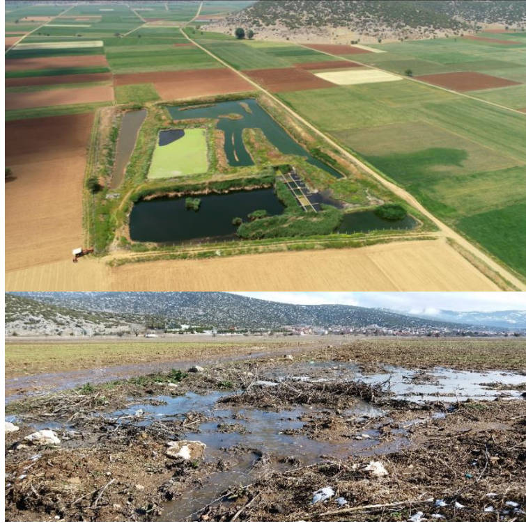
Şekil 5.21: Nikfer YSA alan içi ve nihai yatak hattında taşmalar
