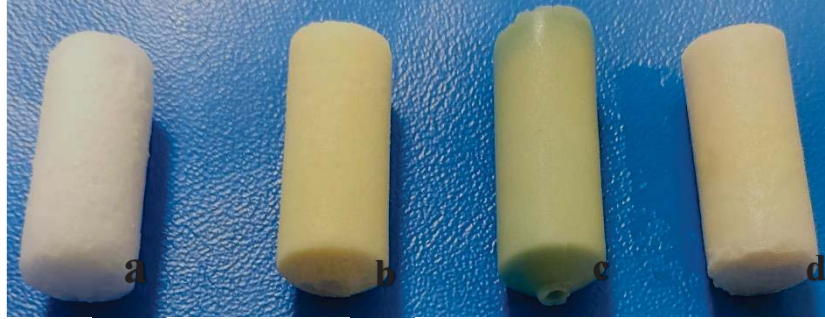
Şekil 7.2: BSA adsorpsiyonunda kullanılmak üzere hazırlanmış kriyojellerin optik görüntüsü: a) poli(HEMA-GMA), b) poli(HEMA-GMA)-NVF, c) poli(HEMA-GMA)-NVF-Cu 2+ , d) poli(HEMA-GMA)-NVF-Zn 2+
