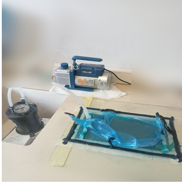
Şekil 6.9: Vakum infüzyon sistemi
