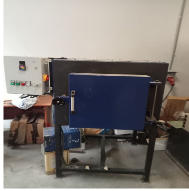
Şekil 6.3.1: Nevola ısıl işlem fırını
