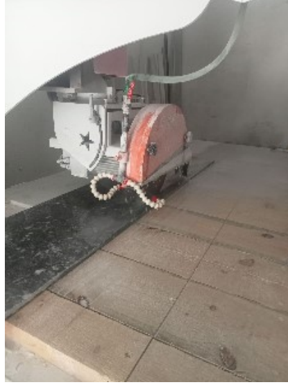
Şekil 6.3.6: Mermer kesim cihazı
