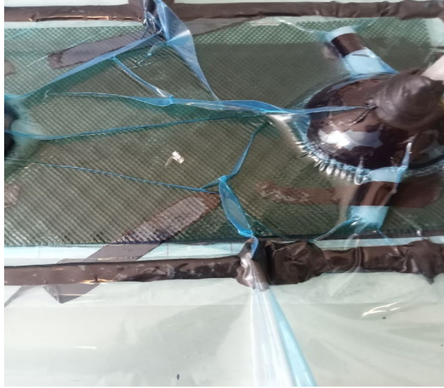
Şekil 6.11: Karbon fiberlerin epoksi ile kaplanması
