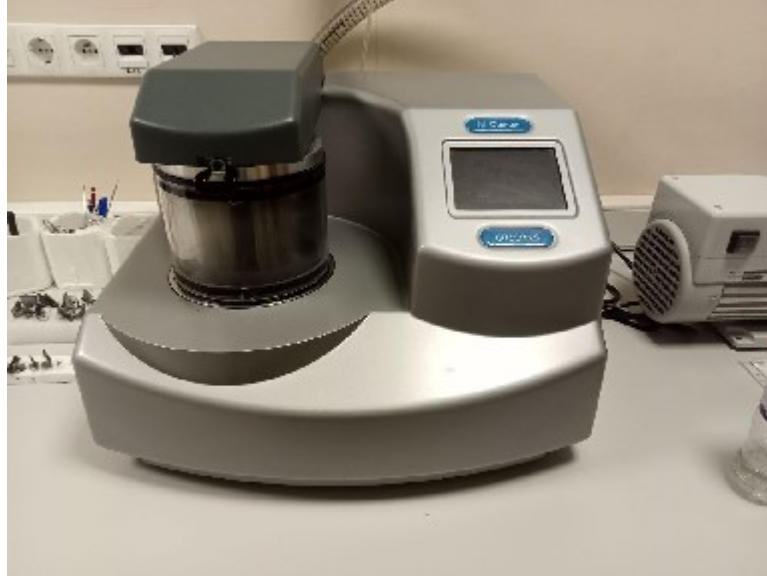
Şekil 6.3.6: Gümüş paladyum kaplama cihazı
