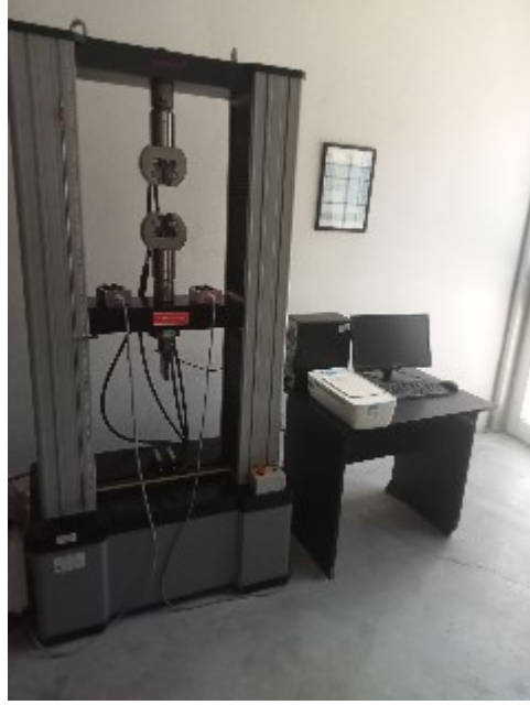
Şekil 6.3.4: Hardway WDW-100 test cihazı
