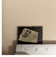
Şekil 6.4: Twill dört katlı yakma testi örneği
