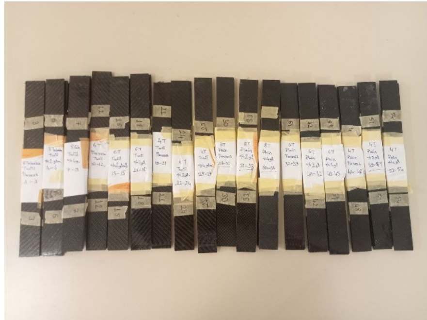
Şekil 6.12: Yarı otomatik mermer makinesi ile kesilen örnekler
