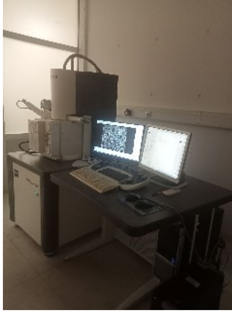
Şekil 6.3.3: Zeiss Supra 40VP alan emisyon mikroskobu
