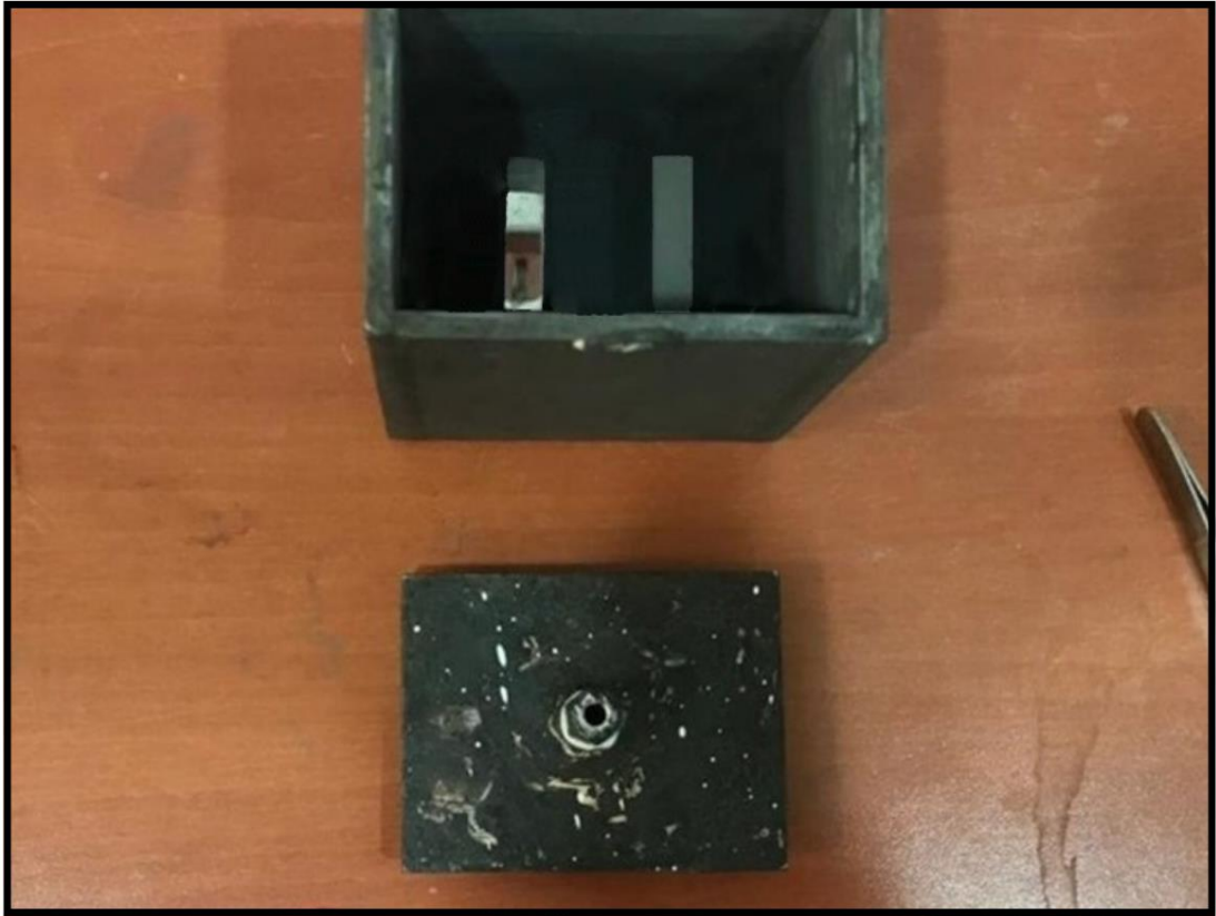
Şekil 5.8: Boro-Sinterleme kutusuna numunelerin dizilişi.
