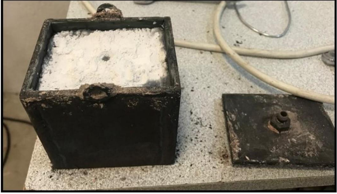
Şekil 5.11: Boro-Sinterleme sonrası kutunun soğumaya bırakılması.
