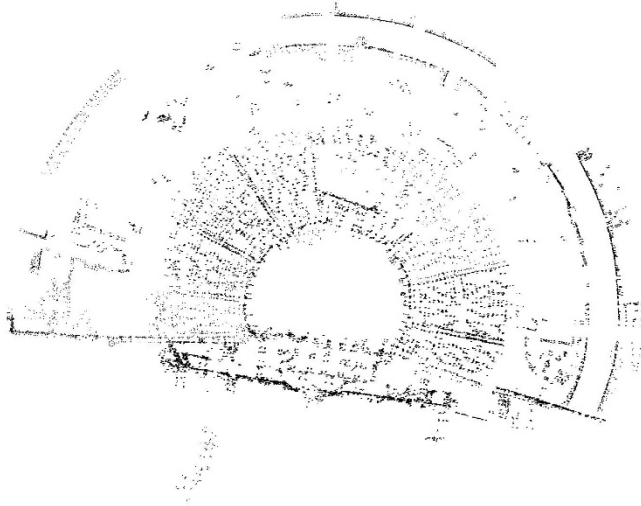
Figür 60. TotalStation ölçümlerinin bir araya getirilmesi sonucu ortaya çıkan nokta bulutunun son aşaması.
