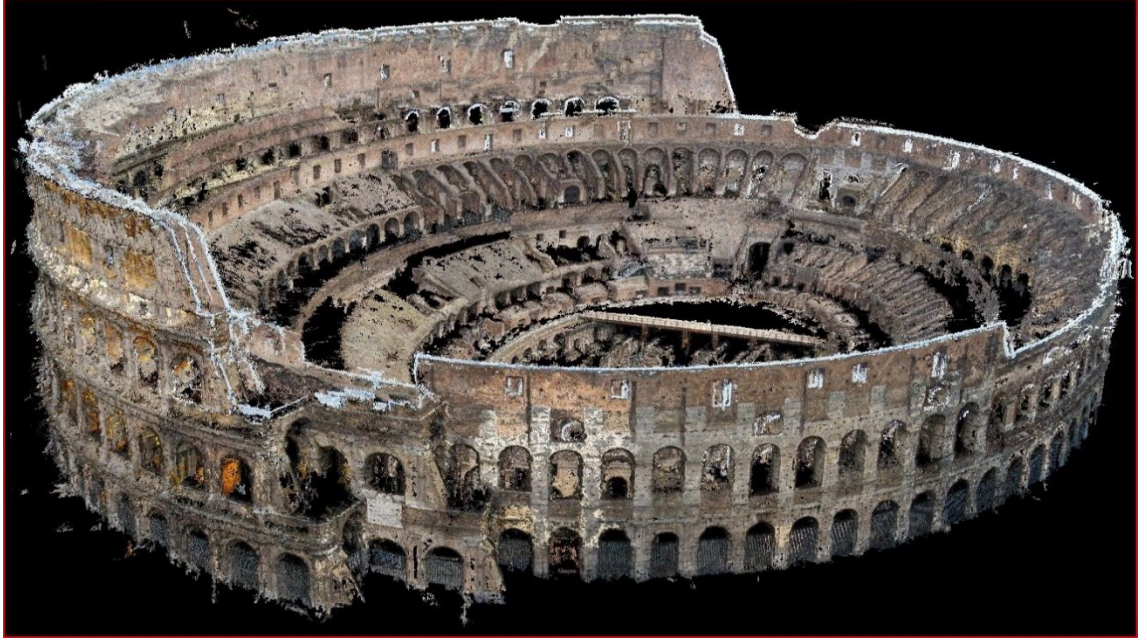
Figür 39. PMVS yazılımı ile üretilmiş 3B model
