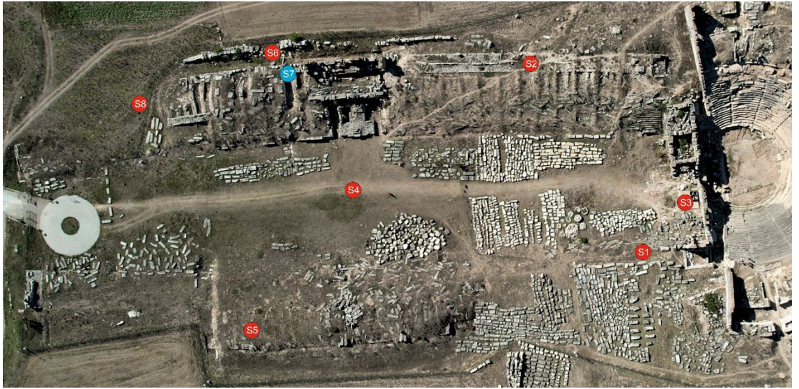
Figür 70. Stadion çalışmaları sırasında TotalStation kurulumu yapılan bölgeler.
