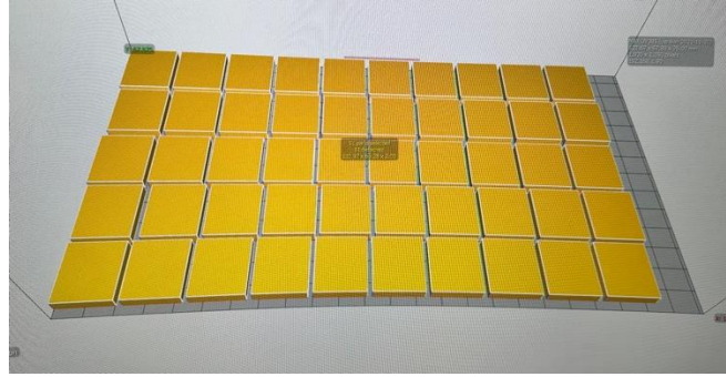
Şekil 3.1. 3B yazıcı örneklerinin tasarımı ve programa yerleştirilmesi
