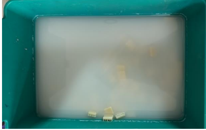
Şekil 3.3. Üretilen Saremco Print Crowntec örneklerin alkol ile yıkanması
