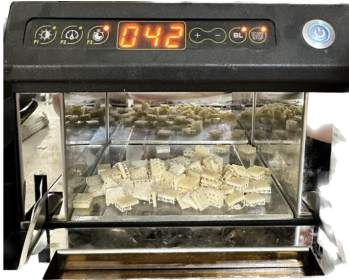
Şekil 3.4. Saremco Print Crowntec örneklerin Power Cure cihazı ile polimerizasyonu
