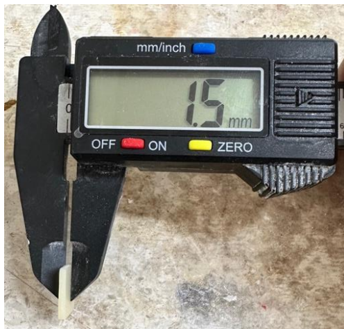
Şekil 3.8. Dijital kumpas ile kalınlık ölçümü
