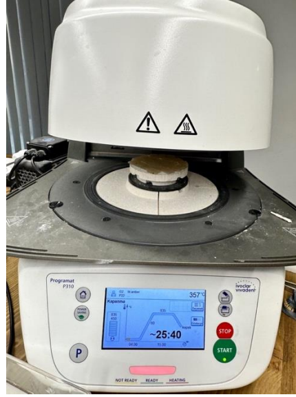
Şekil 3.7. Programat P310 fırın ile kristalizasyon işlemi
