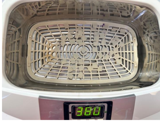
Şekil 3.10. Ultrasonik temizleme cihazında örneklerin temizlenmesi
