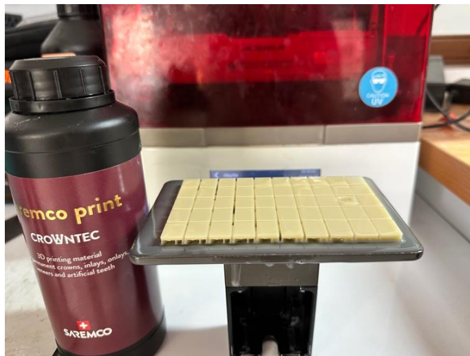
Şekil 3.2. Üretim tablasında yatay doğrultuda üretilen örnekler
