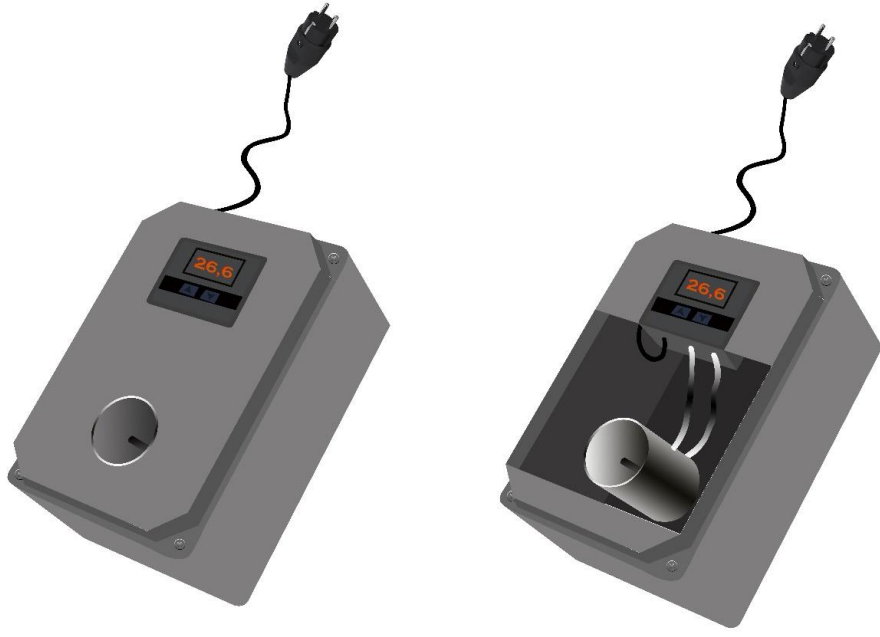
Şekil 3.9. Prototip cihazın dış ve iç görüntüsünün şematik şekli
