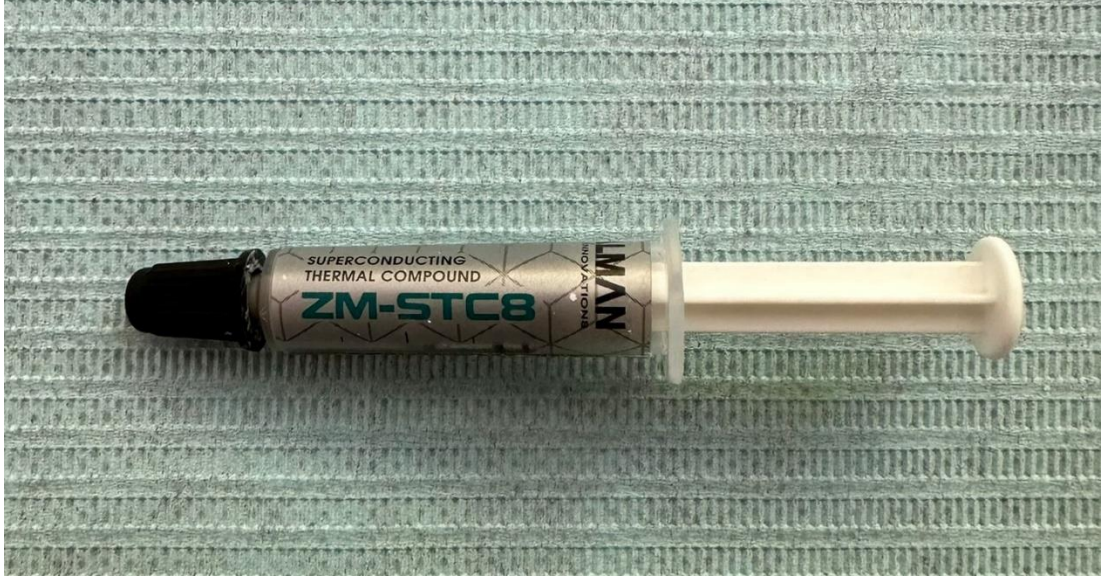
Şekil 3.6. Termokupl ile kök arasındaki ısı iletimini sağlaması için kullanılan termal macun
