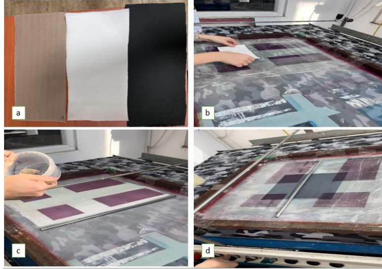
Şekil 3. 6: Baskı işlemi; a) İşlemden kullanılan PES ve PA spacer kumaşlar, b) Spacerın baskı düzeneğine yerleştirilmesi, c) Hazırlanan çözeltinin yerleştirilmesi, d) Spacer kumaş üzerine baskı işleminin gerçekleştirilmesi
