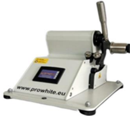
Şekil 4.3: Balistik sarkaç metodu (Elmendorf)
