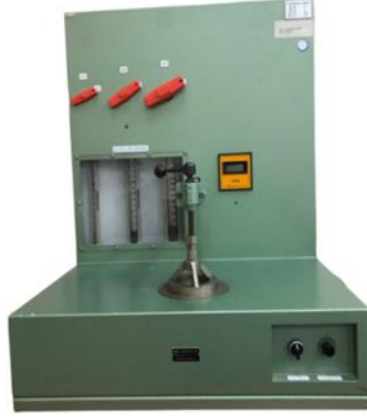
Şekil 4.8: Hava geçirgenliği test cihazı
