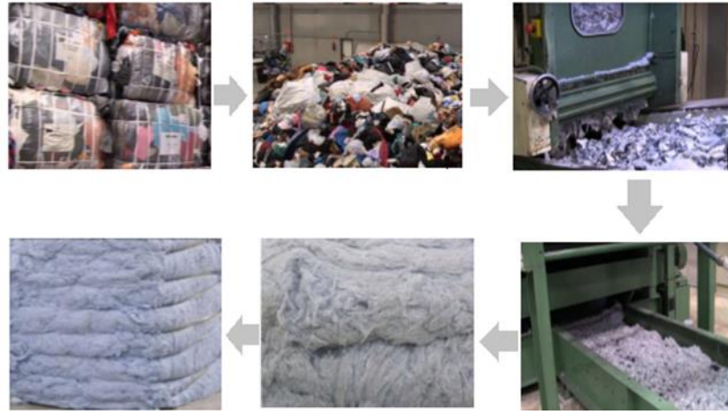
Şekil 1.10: Tüketici sonrası ürünlerin elyafa dönüşmesi (Kadem ve Özdemir 2020)
