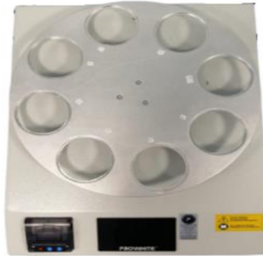
Şekil 4.7: Su buharı geçirgenliği test cihazı
