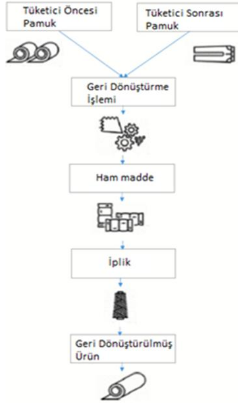
Şekil 1.8: Geri dönüşümlü kumaşların üretim akış şeması
