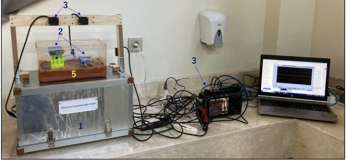
Şekil 7.8: Killi zeminlerin sıvılaştırma model deneyi düzeneği
