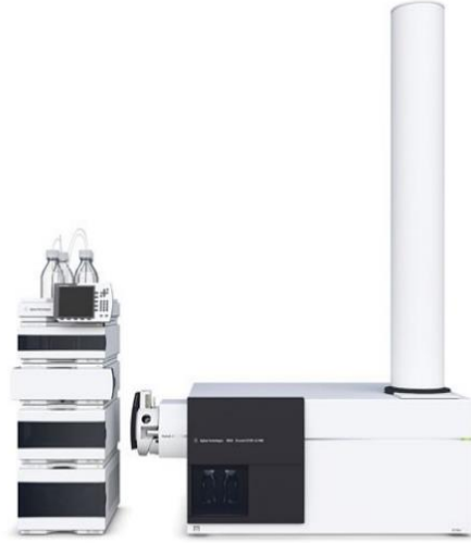
Şekil 5.2: Agilent 6550 QTOF LC/MS cihazı
