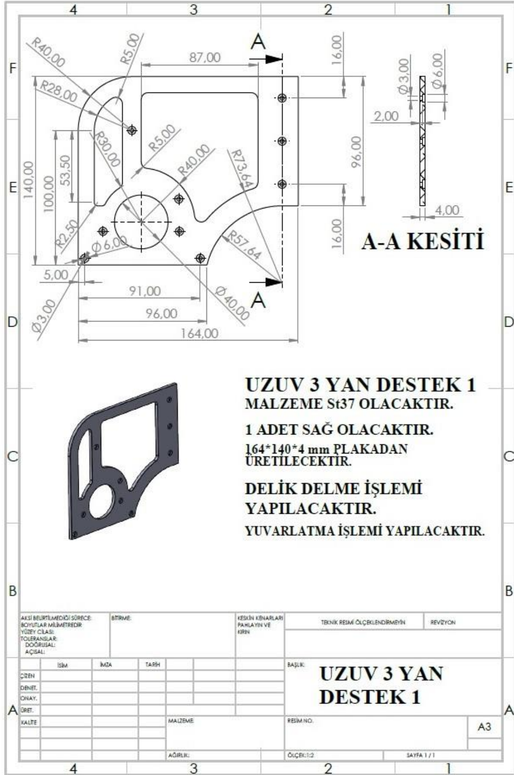
Őekil 2.48. Uzuv3 yan destek1 parça teknik resmi.
