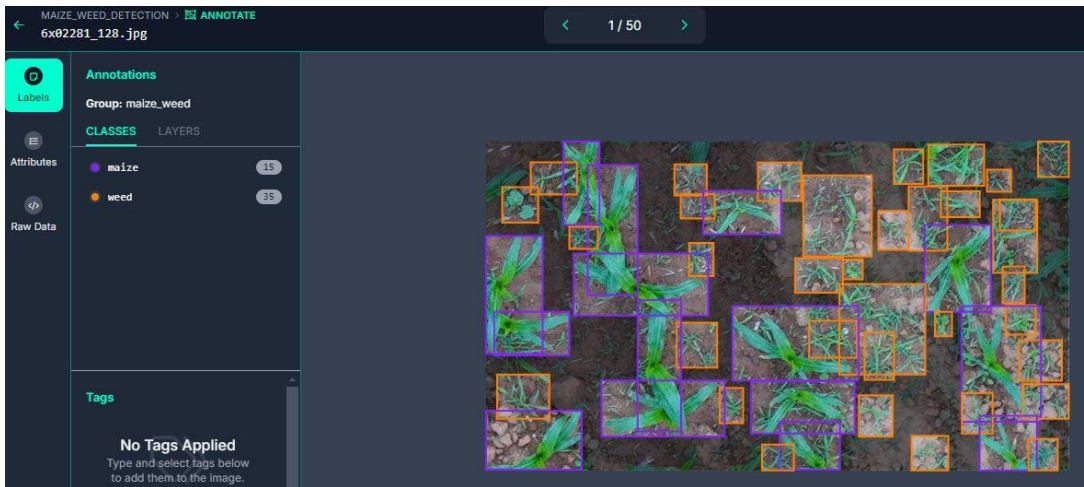
Şekil 4.4: Roboflow ile mısır ve yabancı otların seçilip sınıflandırılması
