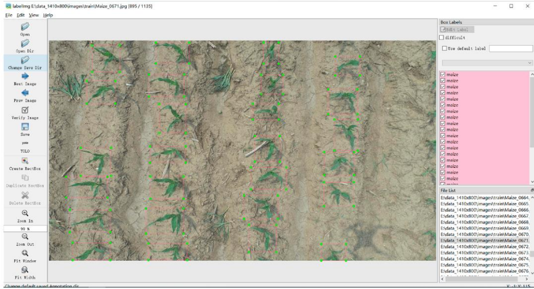
Şekil 4.3: Nesne tespiti işleminden önce mısırların tespiti ve işaretlenmesi (Zhao ve diğ.,2023)
