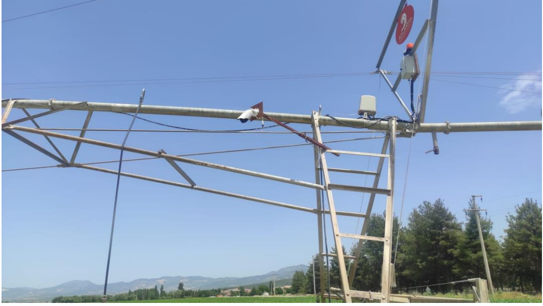
Şekil 4.1: İp kameranın pivot üzerine montajı
