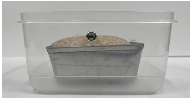
Şekil 2.2: Son fermantasyon uygulaması sırasında hamur yüksekliğinin belirlenmesi için kullanılan sistem.
