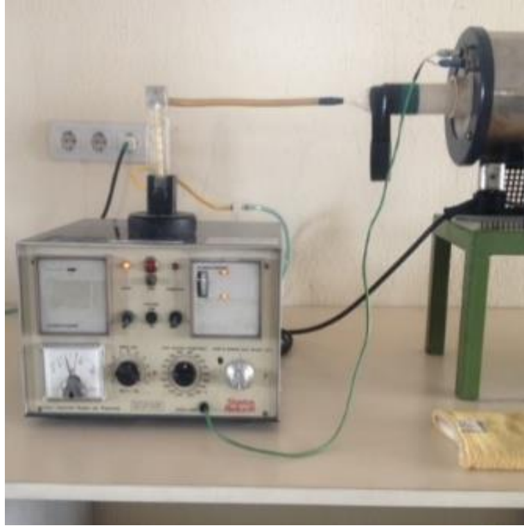
Şekil 3.10: Hava Besleme Sistemi ( Flow metre + Hava pompası )
