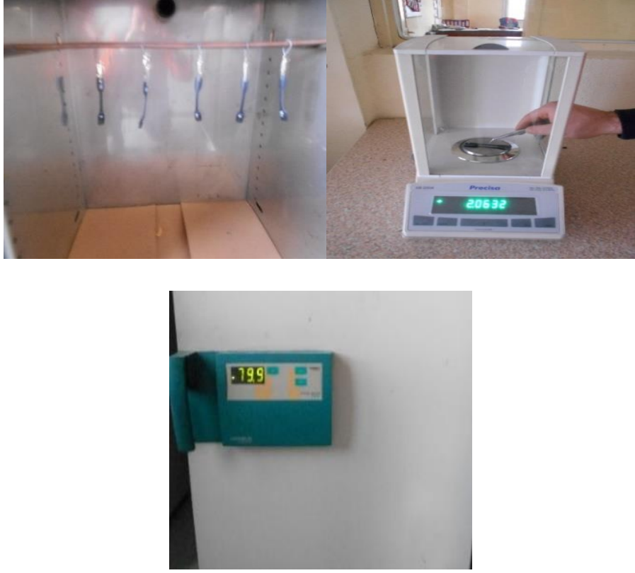
Şekil 3.16: Ağırlık Kaybı Test Ekipmanları
