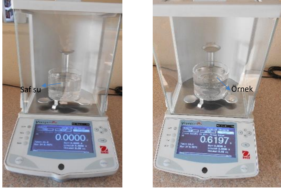
Şekil 3.8: Yoğunluk Ölçer Test Cihazı
