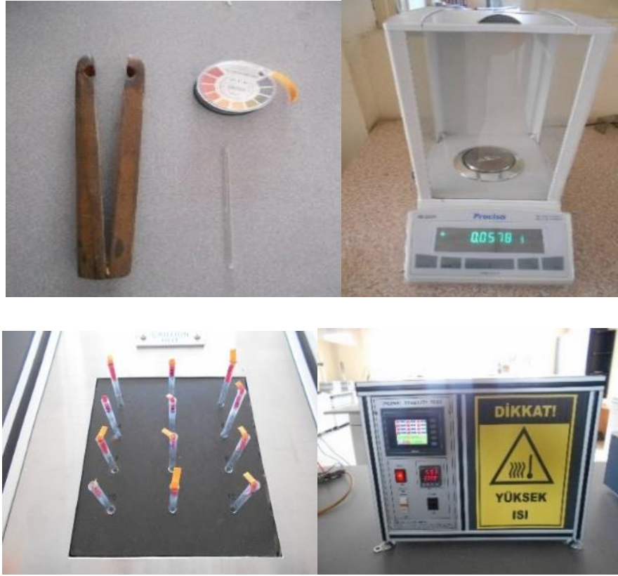
Şekil 3.25: Termik Kararlılık Test Ekipmanları
