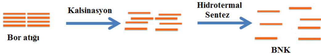
Şekil 3.2: Bor Atığından Bor Nanokil Sentezi Gösterimi
