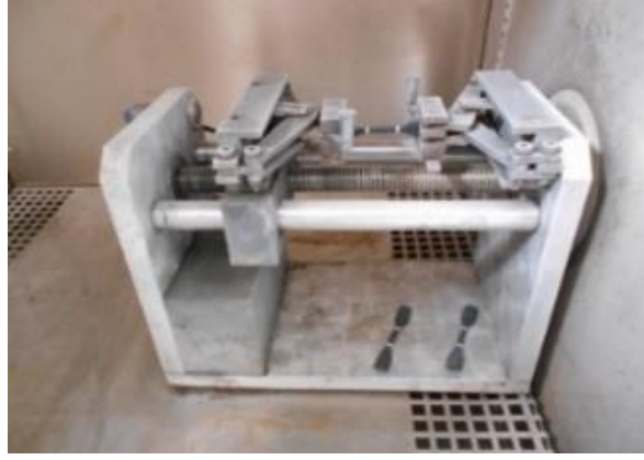
Şekil 3.22: Soğukta Uzama Test Ekipmanları
