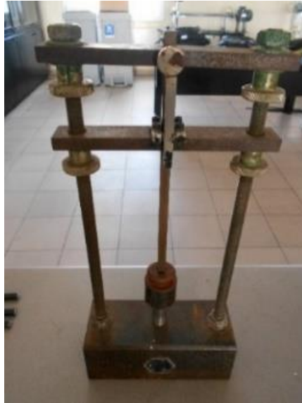
Şekil 3.23: Soğukta Vurma Test Ekipmanları
