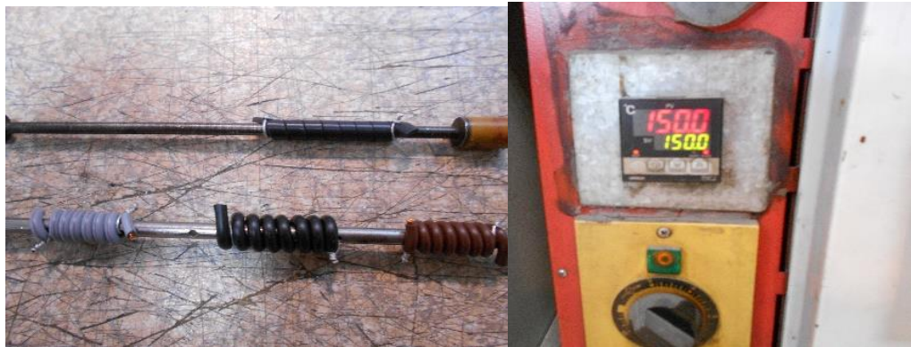
Şekil 3.20: Isı Şoku Test Ekipmanları
