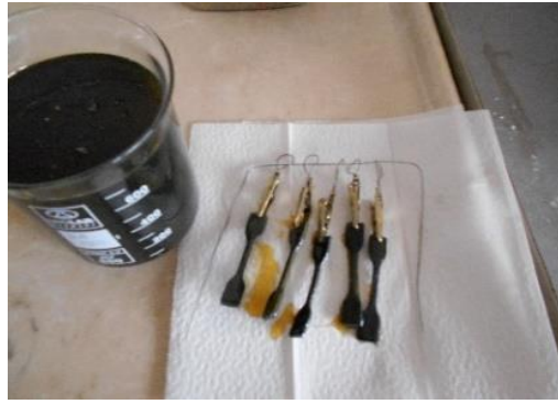
Şekil 3.24: Kimyasal Dayanım Test Ekipmanları
