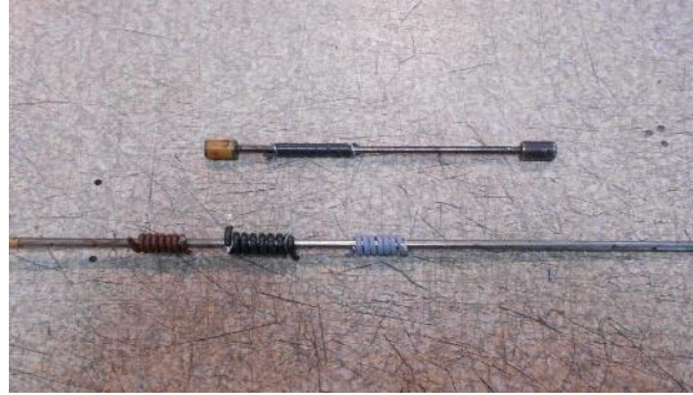
Şekil 3.19: Isı Şoku Numune Hazırlama
