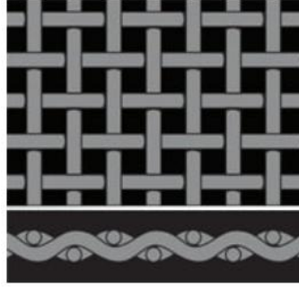
Şekil 2.3 Düz dokuma tel örgü yapısı (Locker 2024).
