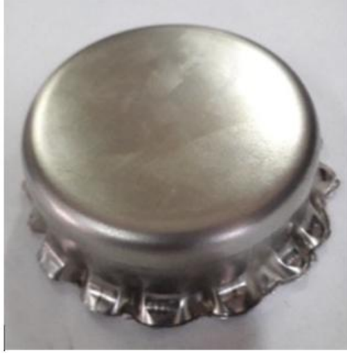
Şekil 2.17 Derin çekme işleminde kırışma hasarı (Ghafar ve diğ. 2021).
