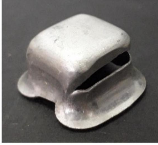
Şekil 2.16 Derin çekme işleminde kırılma hasarı (Ghafar ve diğ. 2021).
