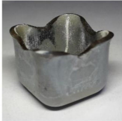
Şekil 2.18 Derin çekme işleminde kulaklama hasarı (Ghafar ve diğ. 2021).
