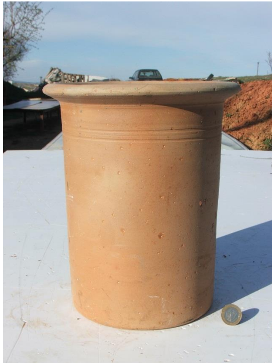
Fotoğraf 55: Kireç Atmasının Gözlemlenebileceği Ürün
