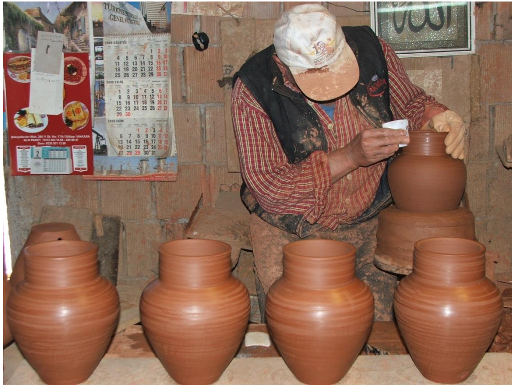
Fotoğraf 42: Perdahlama (Torna) İşlemi
