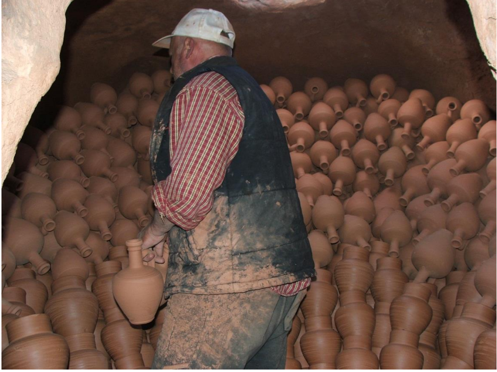
Fotoğraf 45: Fırının Doldurulması
