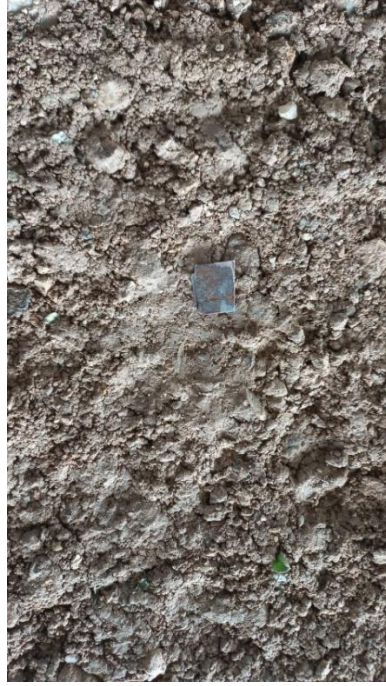
Şekil 2.46: Sürtünme katsayı deneyi için S235JR malzeme ve toprak görüntüsü
