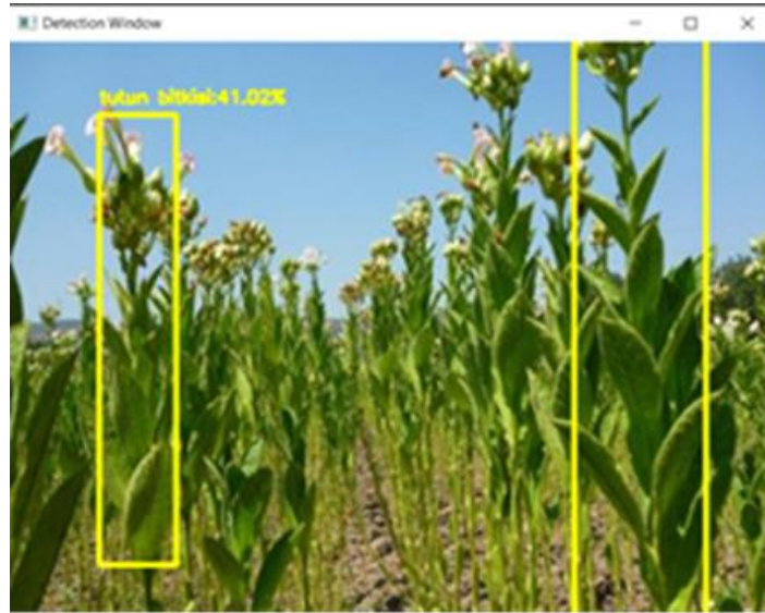
Şekil 2.70: Uzun bitkilerin bulunduğu ortamda kameradan alınan görüntü üzerinden tütün bitkisinin tespiti
