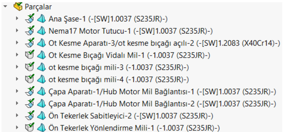
Şekil 2.19: Robot parçalarının malzemelerinin tanımlaması
