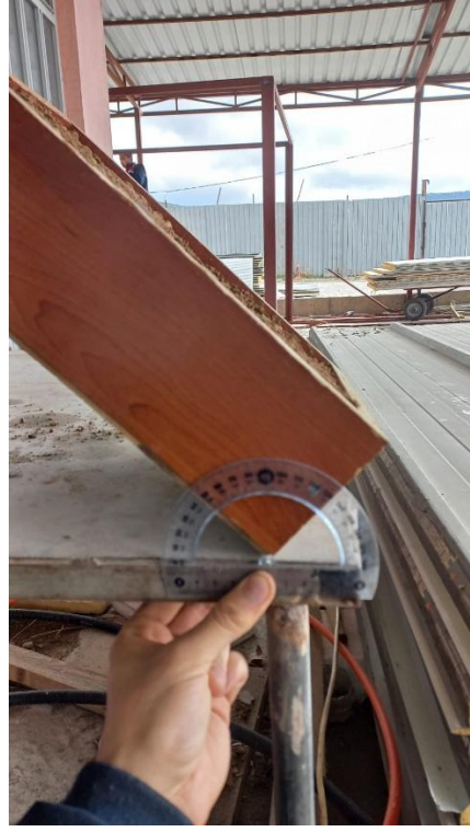
Şekil 2.48: Sürtünme katsayı deneyi açıölçer ile ölçme işlemi
