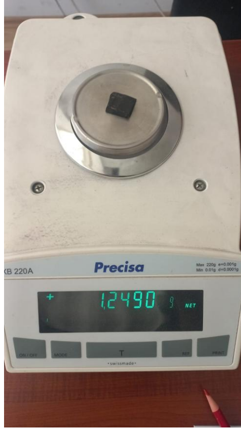
Şekil 2.53: Sürtünme katsayı deneyi için kauçuk malzemenin kütlesinin ölçümü
