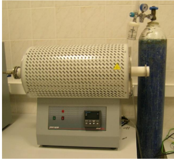
Şekil 3.4: Honeywell sıcaklık kontrol ünitesi Protherm marka tüp fırın.
