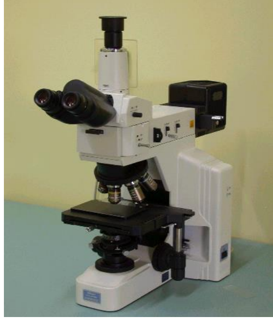
Şekil 3.8: Nikon ECLİPSE ME600 marka polarize ışık mikroskobu.
