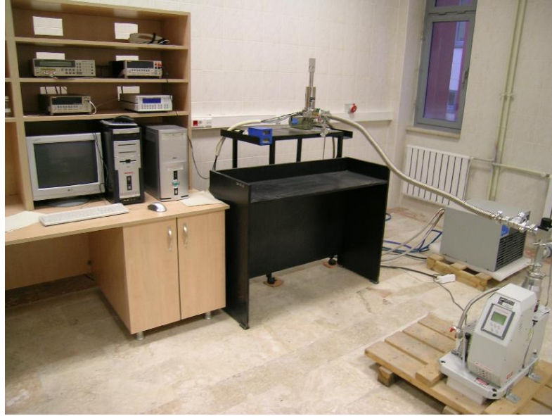
řekil 3.9: Sıcaklıđa bađlı direnç ölçüm sistemi.
