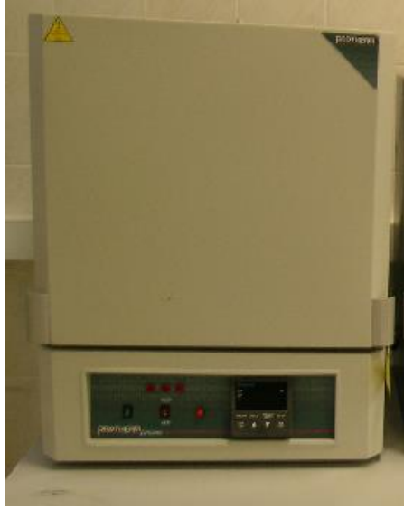
Şekil 3.1: Honeywell sıcaklık kontrol üniteli Protherm marka kare fırın.
