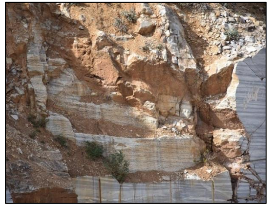
Resim 19. Resim Prokonnesos Taş Ocağında Taşların Anakayadan Koparılması Sırasında Oluşan Testere ve Çekiç İzleri.
