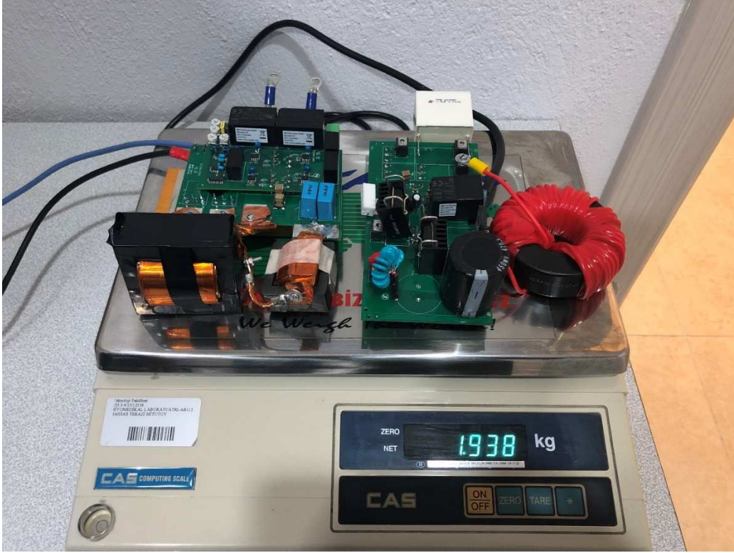
Şekil 43. İki aşamalı prototipin tartılması.
