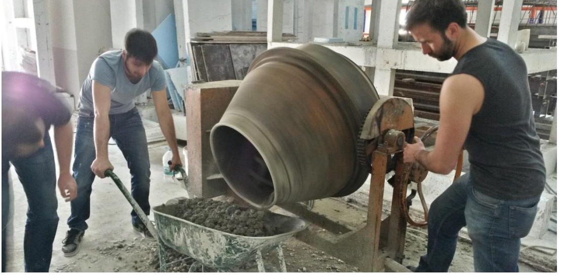
Œekil 3.6: Hazırlanan KarıŒımın Betoniyerden BoŒaltılması
