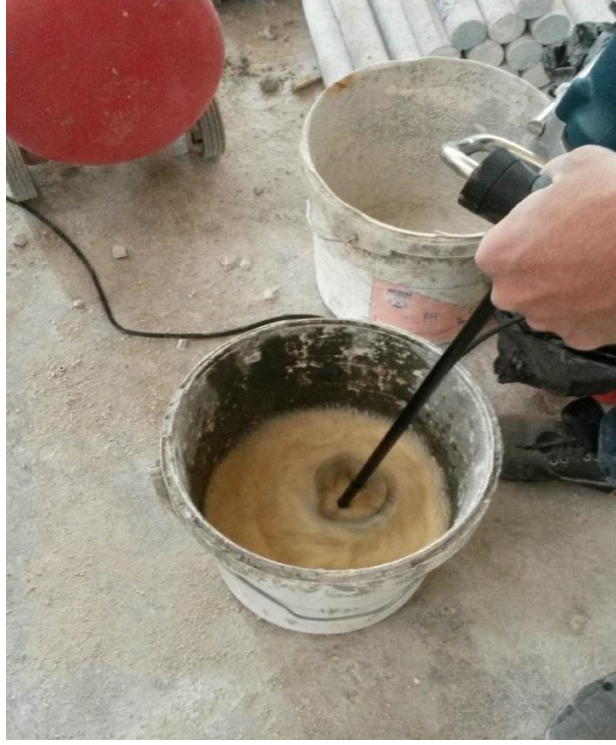
Şekil 3.4: Traverten-Su Karışımının Hazırlanması
