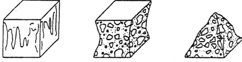
Şekil 3.9: Tatmin Edici Kırılma Biçimleri
