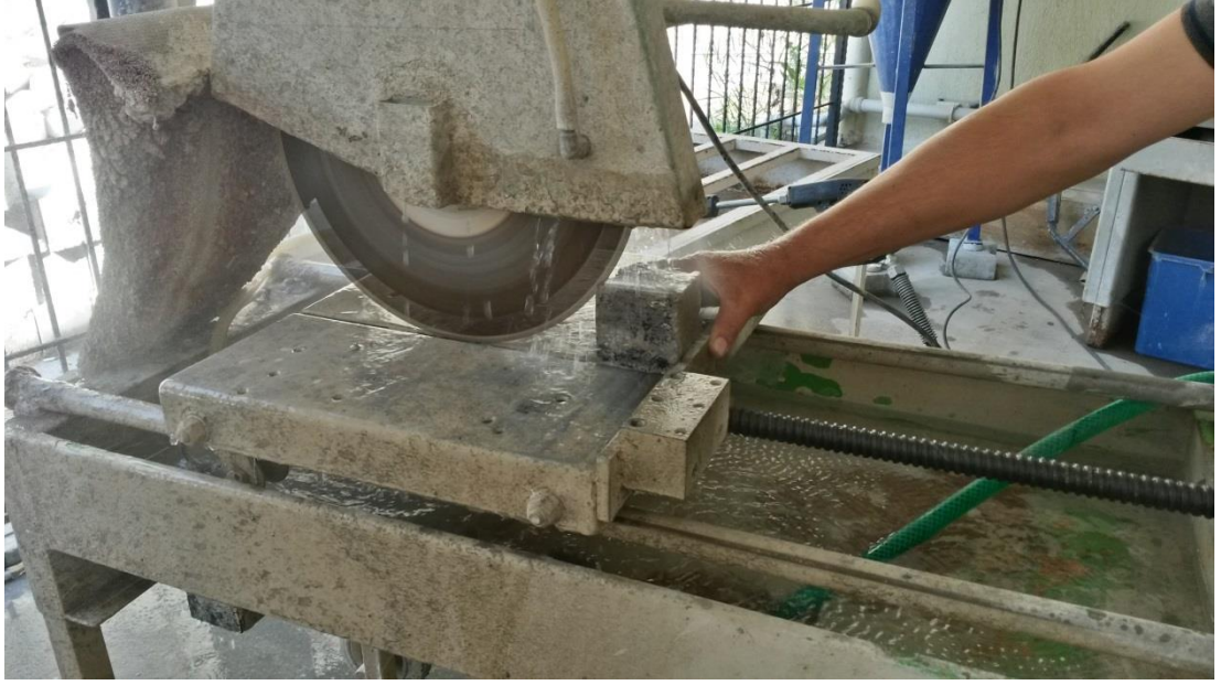
Şekil 3.17: Numunenin aşındırılacak yüzeyinin düzeltilmesi
