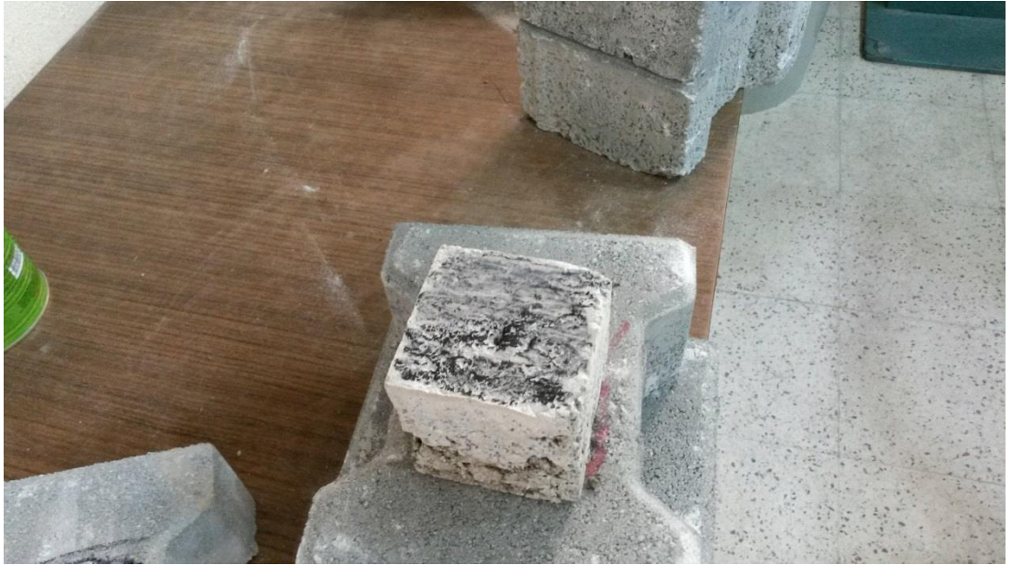
Şekil 3.18: Numunenin aşındırılacak olan yüzeyinin kalemle boyanması
