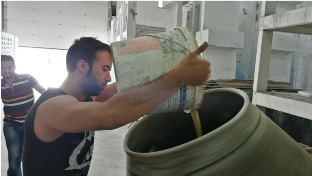
Şekil 3.5: Hazırlanan Traverten-Su Karışımının Sisteme Verilmesi
