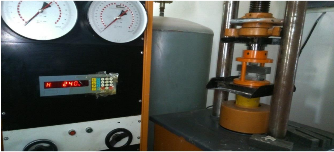
Şekil 3.2: Eğilme Dayanımı Testi Ölçüm Düzeneği
