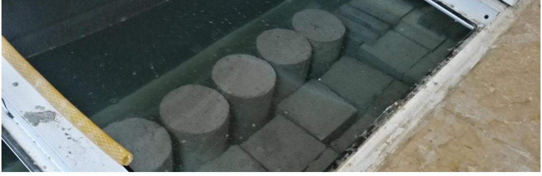
Şekil 3.8: Numunelerin Kür Havuzunda Muhafaza Edilmesi
