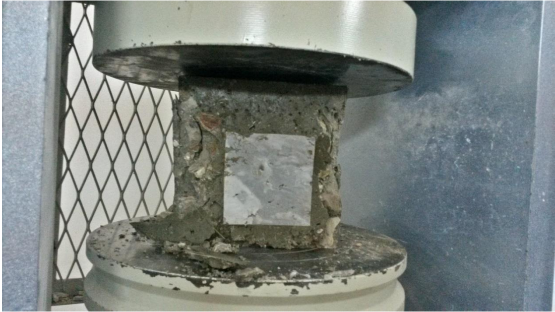
Şekil 3.11: Basınç Testi Sonrası Numune
