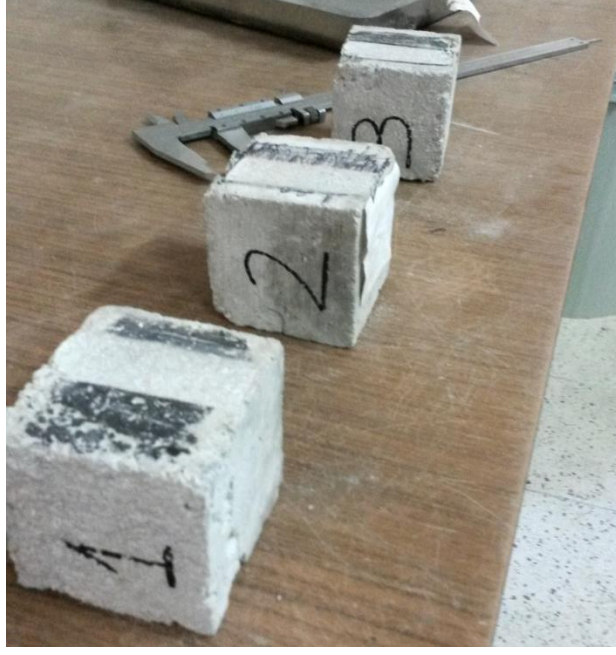
Şekil 3.21: Aşınma Testi Sonrası Numuneler
