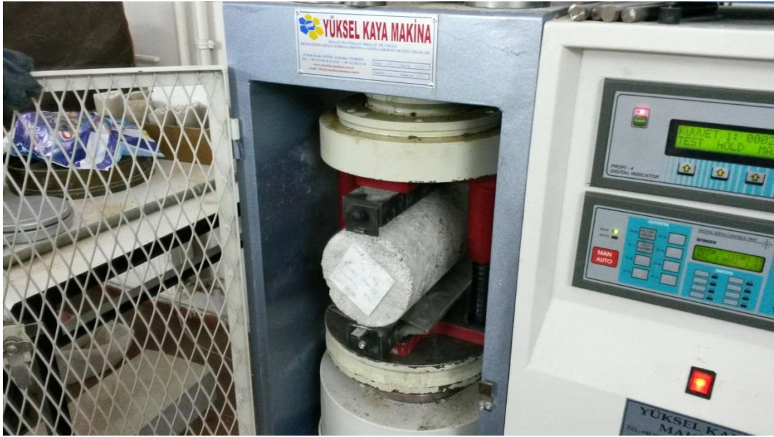
Şekil 3.14: Silindirik Numunenin Yarmada Çekme Aparatına Yerleştirilmesi
