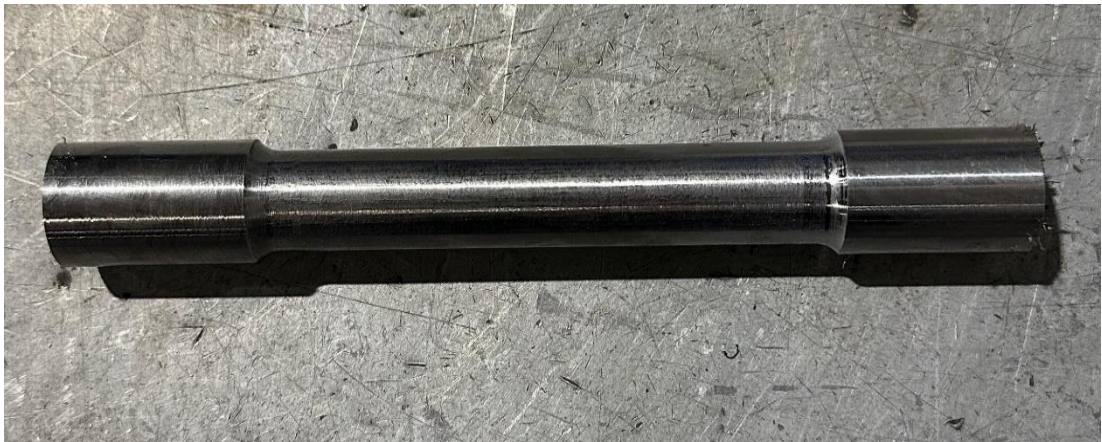
Şekil 6.1: Çekme test numunesi tornada işlenmiş hali
