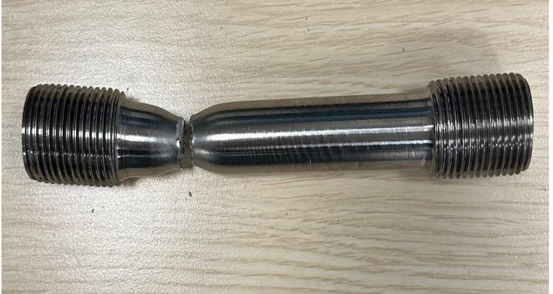
Şekil 6.3: Çekme testi yapılan numune
