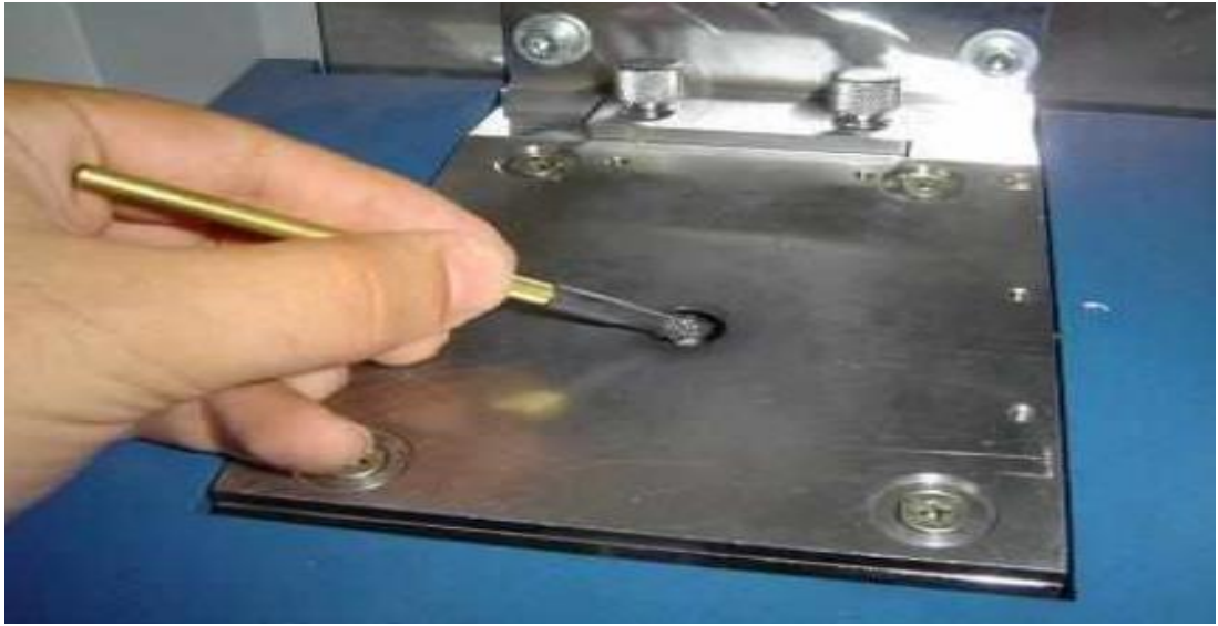
Şekil 6.11: Elektrotun tel fırça ile temizlenmesi
