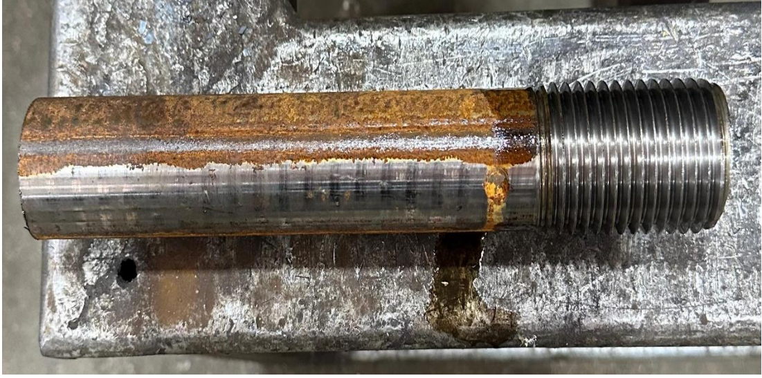
Şekil 6.19: Ovalama prosesi ile vida dış profilinin oluşturulması
