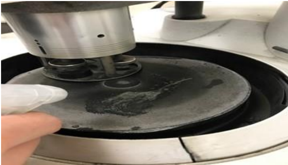
Şekil 6.42: Parlatma disk ilet yerleştirilmesi ve parlatma sıvısı sıkılması
