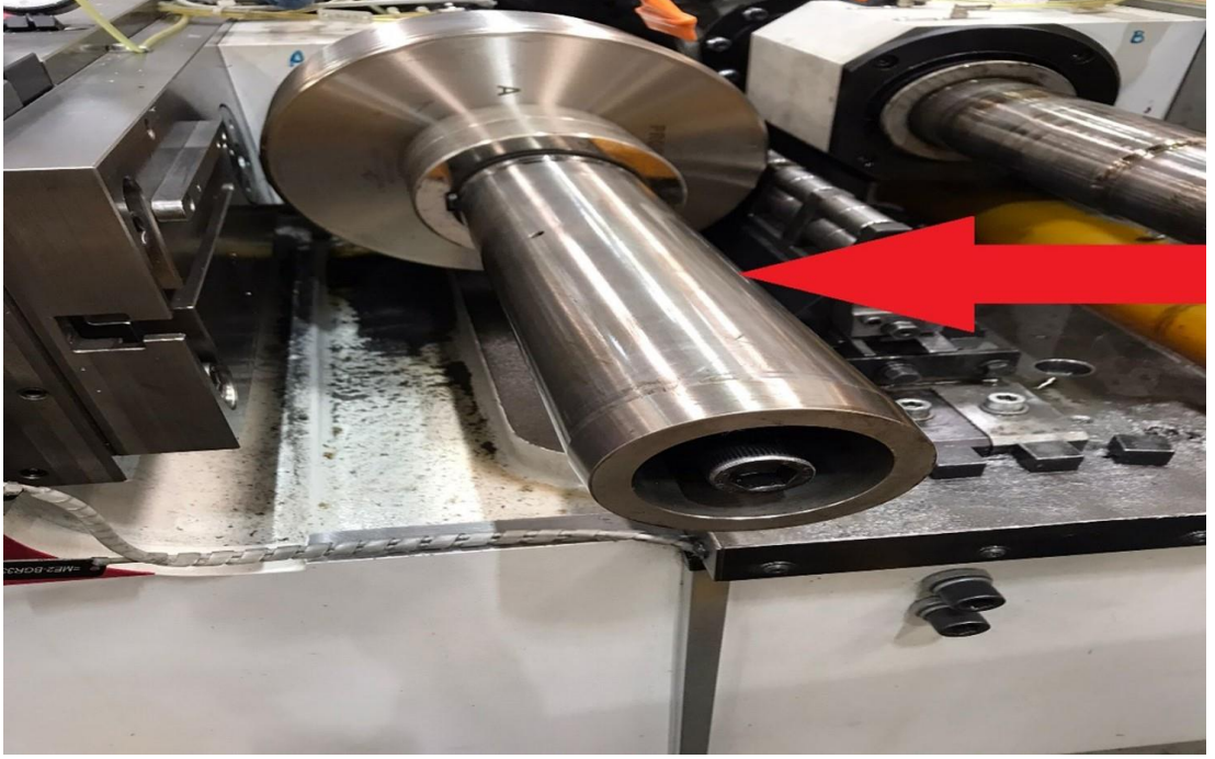
Şekil 6.14: Ovalama makinesine ovalama toplarının takılması
