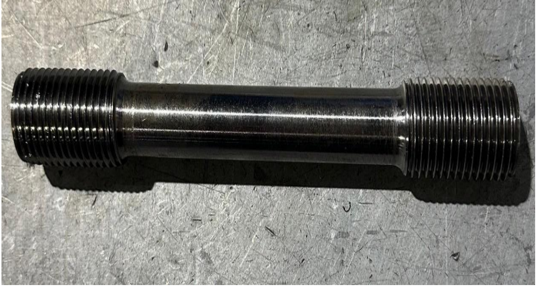
Şekil 6.2: Diş açılmış çekme test numunesi
