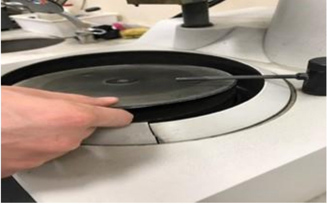
Şekil 6.37: Zımparalama diskinin makineye yerleştirilmesi
