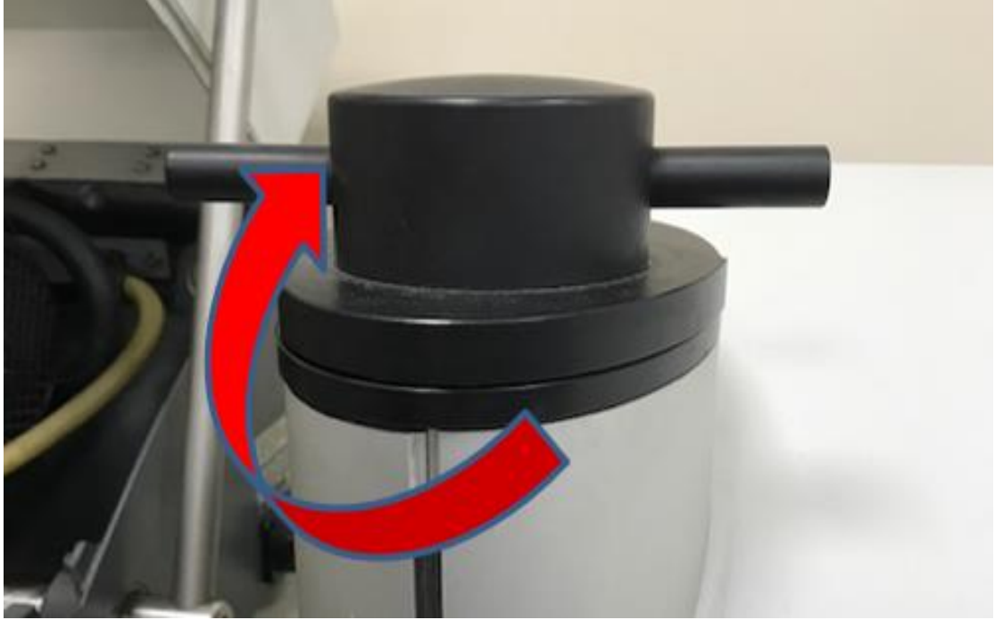
Şekil 6.32: Bakalit tozu eklenmesi sonrası makinenin kapağının kapatılması
