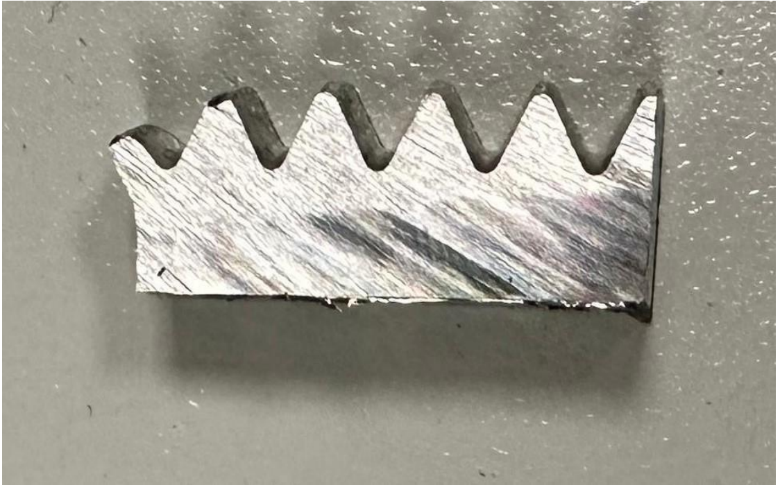
Şekil 6.27: Bakalite gömülecek numune
