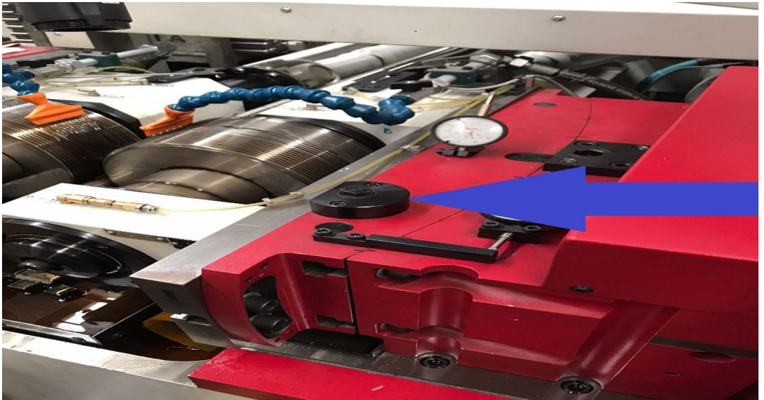
Şekil 6.15: Ovalama topu açısı ayar cıvatası
