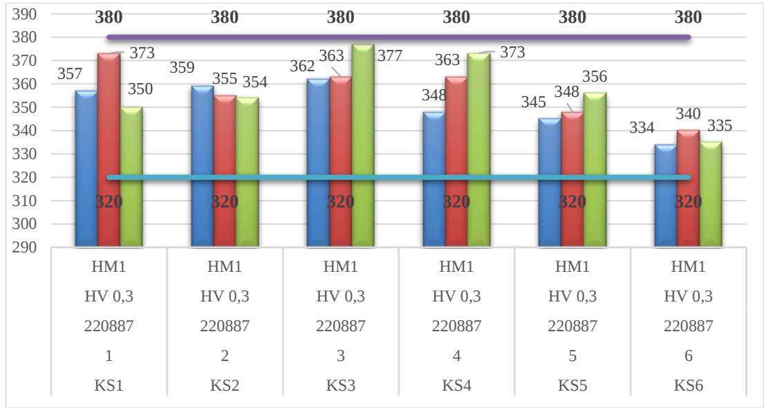
Şekil 7.1: Kesme yöntemi ile vida diş profili oluşturmada sertlik dağılımı grafiği
