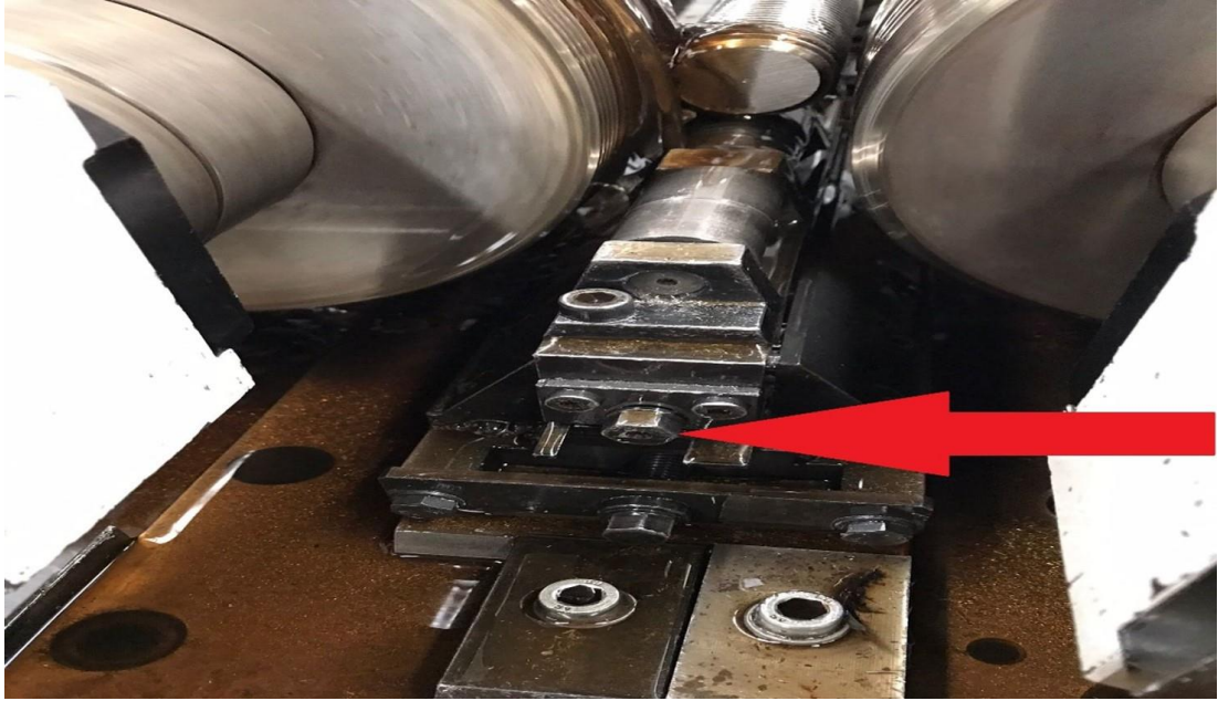
Şekil 6.16: Ovalama makinesi dayama takozu ayarı
