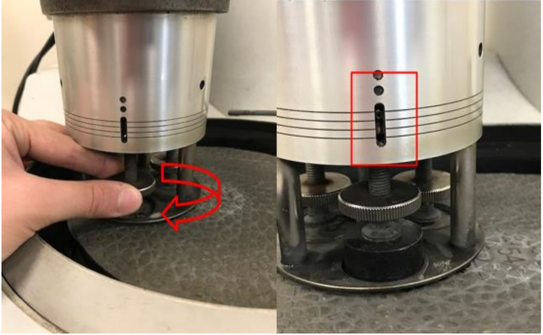
Şekil 6.39: Zımparalama makinesi bakalit yerleştirme ve zımparalama sıkma ayarı
