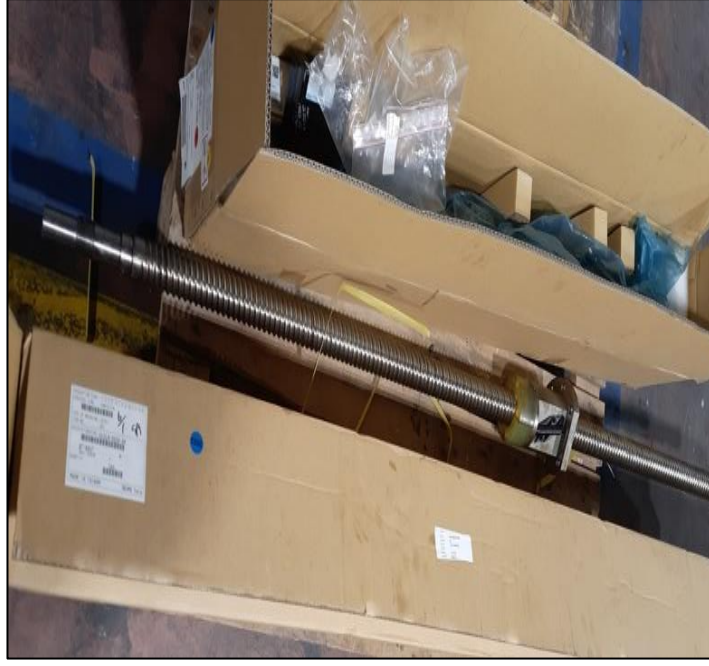
Şekil 4.25: CFA06 tezgâh vidalı mil (devam)
