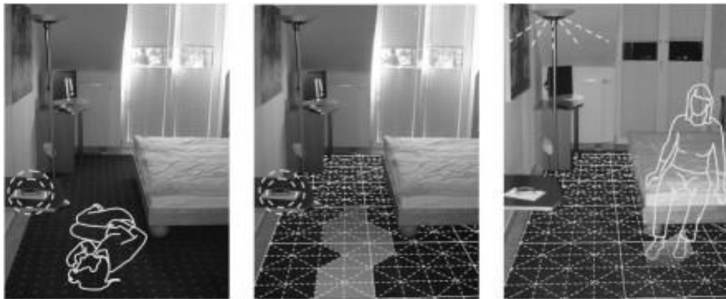
Şekil 2. 22: Yaşlı evinde sensör halı uygulaması (Steinhage ve Lauterbach 2008)
