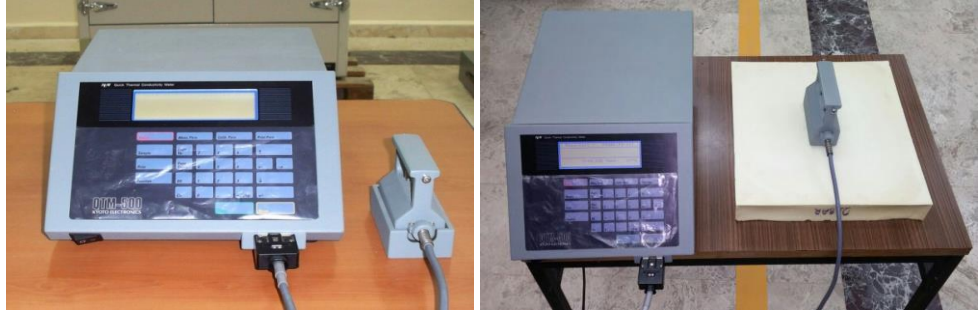
Şekil 3.24 : Kyoto QTM-500 ısı iletim katsayısı ölçüm cihazı ve ölçümün yapılması
