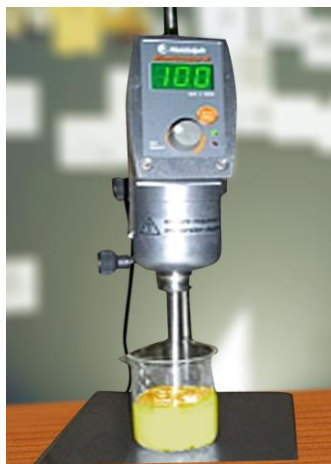
Şekil 3.18 : (a) Poliöl içerisinde ilave edilen alev geciktirici ve/veya dolgu maddesinin homojenizatör ile dağılımının sağlanması (b) İlaveli poliöl ve izosiyanatın mekanik karıştırıcıda karıştırılması
