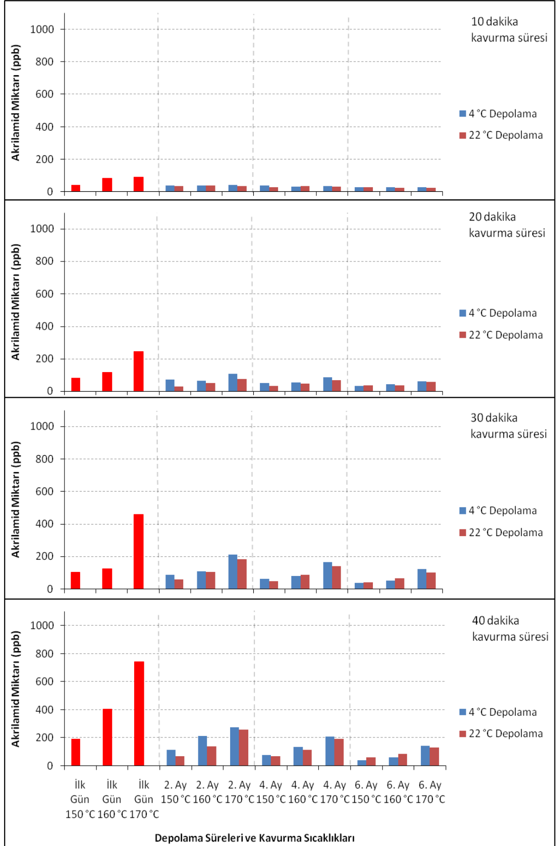
Şekil.4.7 Farklı sıcaklık ve sürelerde kavru lan ve farklı sıcaklıklarda 6 ay süreyle depolanan Akbadem örneklerinin akrilamid miktarları
