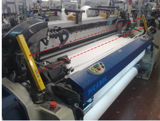
Şekil 10. Gelişmiş model tarak fotosel tertibatı, daha geniş koruma sağlamaktadır.
