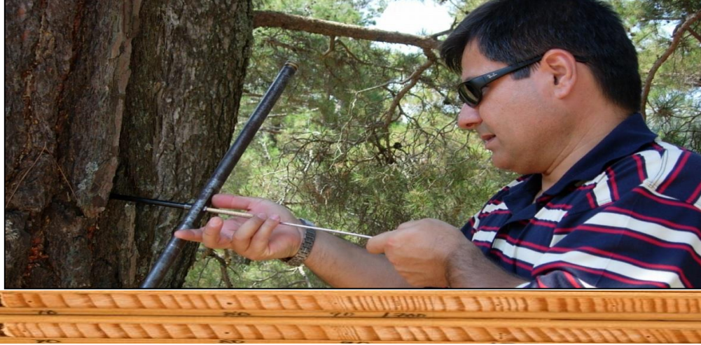
Foto 1. Pressler artım burgusu ile ağaçtan örnek alma işlemi. Altta ise alınan örneklerin çıtalanmış hali görülmektedir.
