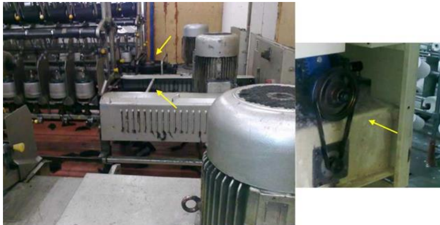
Şekil 8. Kayış kasnak koruyucuları çıkartılmış vaziyette çalıştırılan büküm makinası
