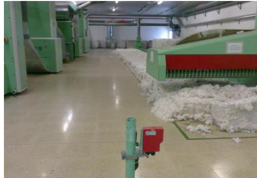
Şekil 2. Tehlikeli alana girilmesi halinde balya yolucunun hareketini durduran fotosel tertibatı.
