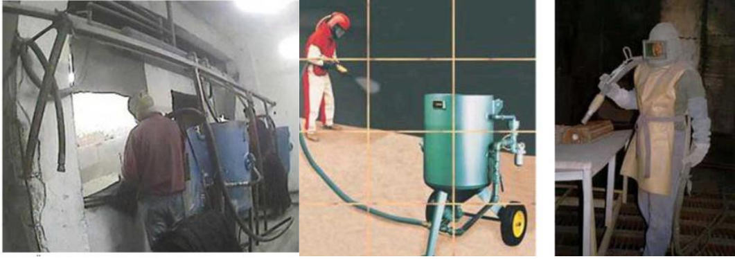
Şekil 14. İş Güvenliği Tedbirleri Alınmadan Uygunsuz Şekilde Yapılan Kot Kumlama İşİ/ Şekil 15. Kumlama İşlemlerinde Tozun Önlenemediği Durumlarda Kullanılması Gereken Dışarıdan Havalandırılan Kişisel Koruyucu Maske ve Giysi
