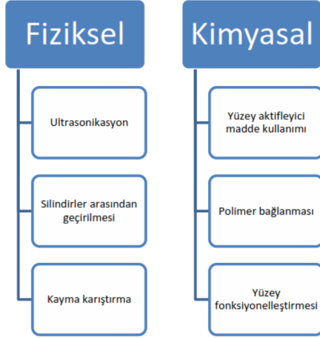
Şekil 2.11: Karbon nanotüplerin polimer matris içerisinde dağıtılmasında kullanılan bazı fiziksel ve kimyasal yöntemler (Eskizeybek 2012).
