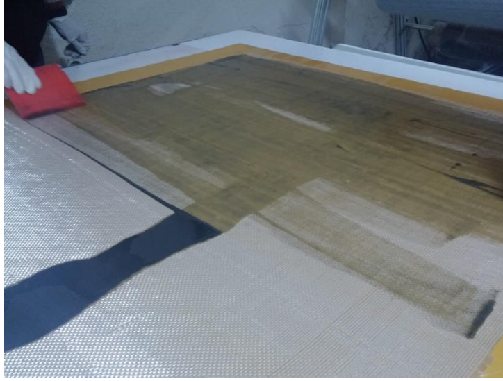
Şekil 3.3: Epoksi reçine karışımının cam elyaf kumaşlara emdirilmesi
