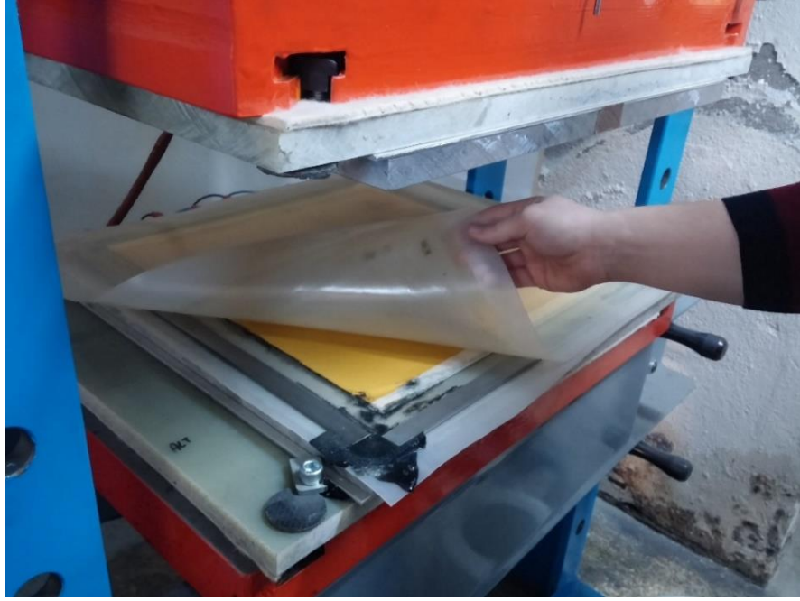
Şekil 3.5: Katmanlanan pre-preg kumaşların 120 °C ye ısıtılmış hidrolik preste k rleşmesi
