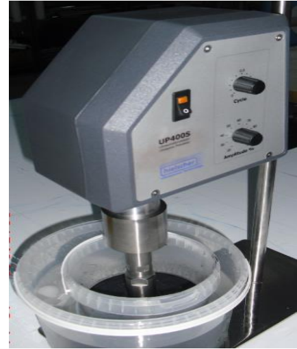
Şekil 3.2: Epoksi ile KNT'nin karıştırılması
