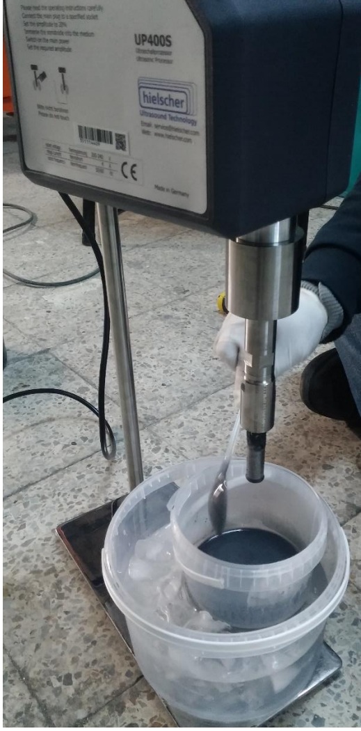
Şekil 3.2: Epoksi ile KNT'nin karıştırılması
