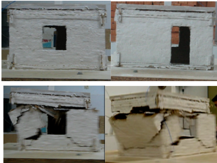
Sekil 4.24 YSN2 numunesi hasar siralamasi
