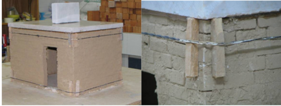
Sekil 4.23 YSN2 numunesi yatay ard germe detay görünümü
