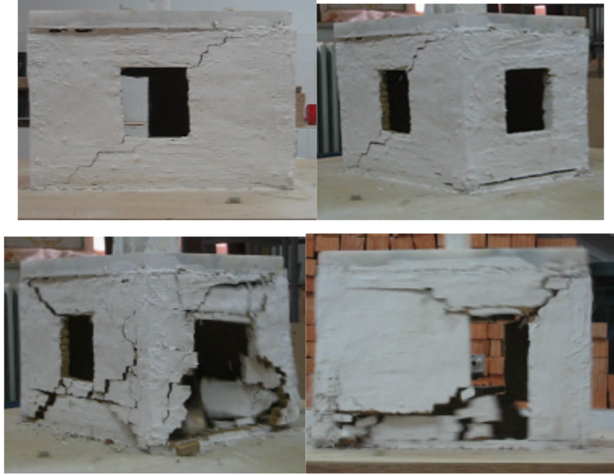
Sekil 4.10 KEYGN3 numunesi göçme sirasi
