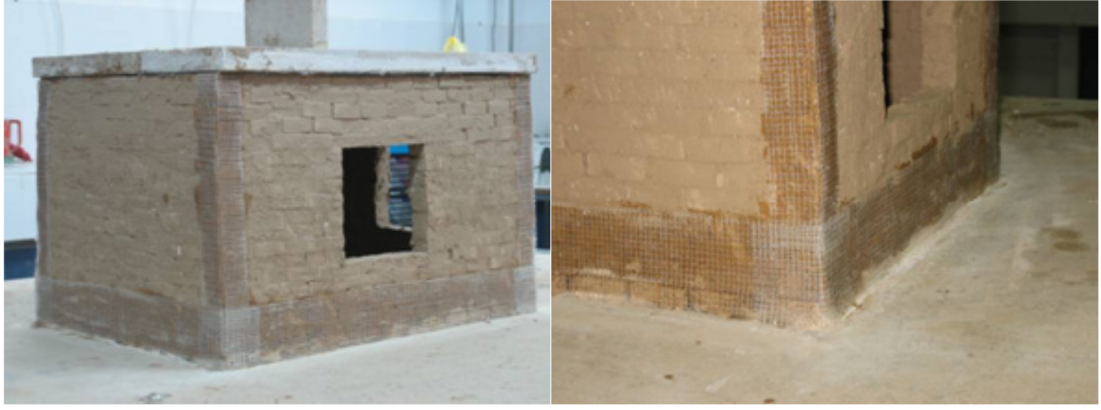
Sekil 4.7 KEYGN2 numunesinin hazirlanisi ve detaylari
