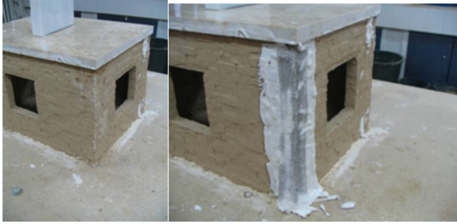
Sekil 4.18 Numune köselerinin alçı ve sinek teli ile kaplanması aşamaları
