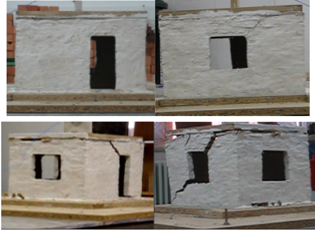
Sekil 4.1 Referans numune RN1 için hasar ve göçme sirasi
