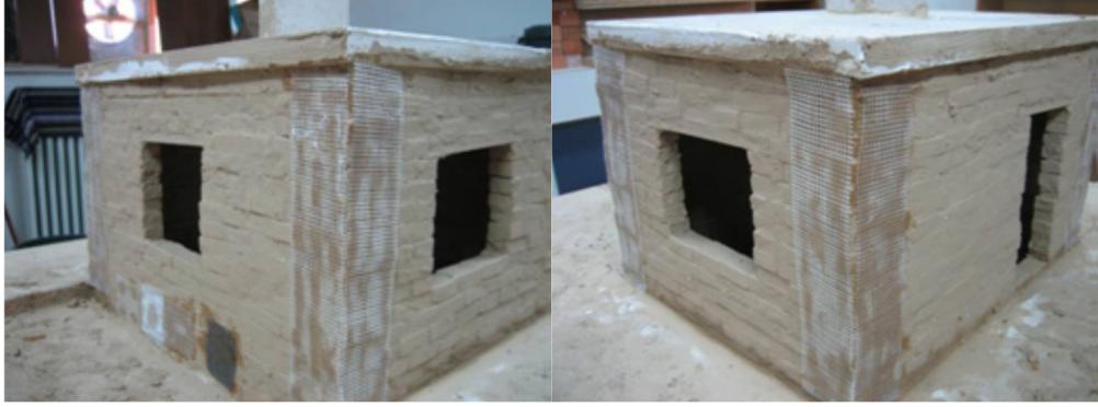
Sekil 4.3 CFRP yaygilar ile duvar kösesinin sa rılması
