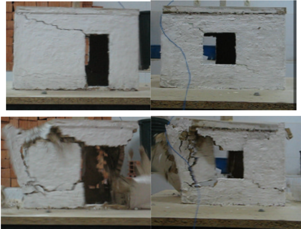
Sekil 4.8 KEYGN2 numunesi göçme sirasi
