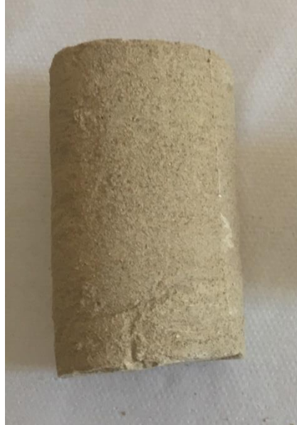
Şekil 4.16: Kohezyonlu güçlendirilmiş zemin
