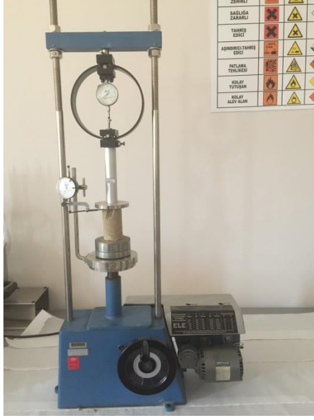
Şekil 4.17: Güçlendirilmiş zeminde yapılan tek eksenli basma deneyi örnekleri
