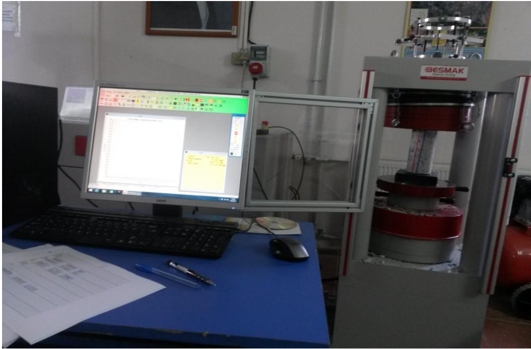
Şekil. 4.13: Çapı D100 mm olan karotları test etmek için kullanılan Beton Basınç Dayanımı Test Makinası
