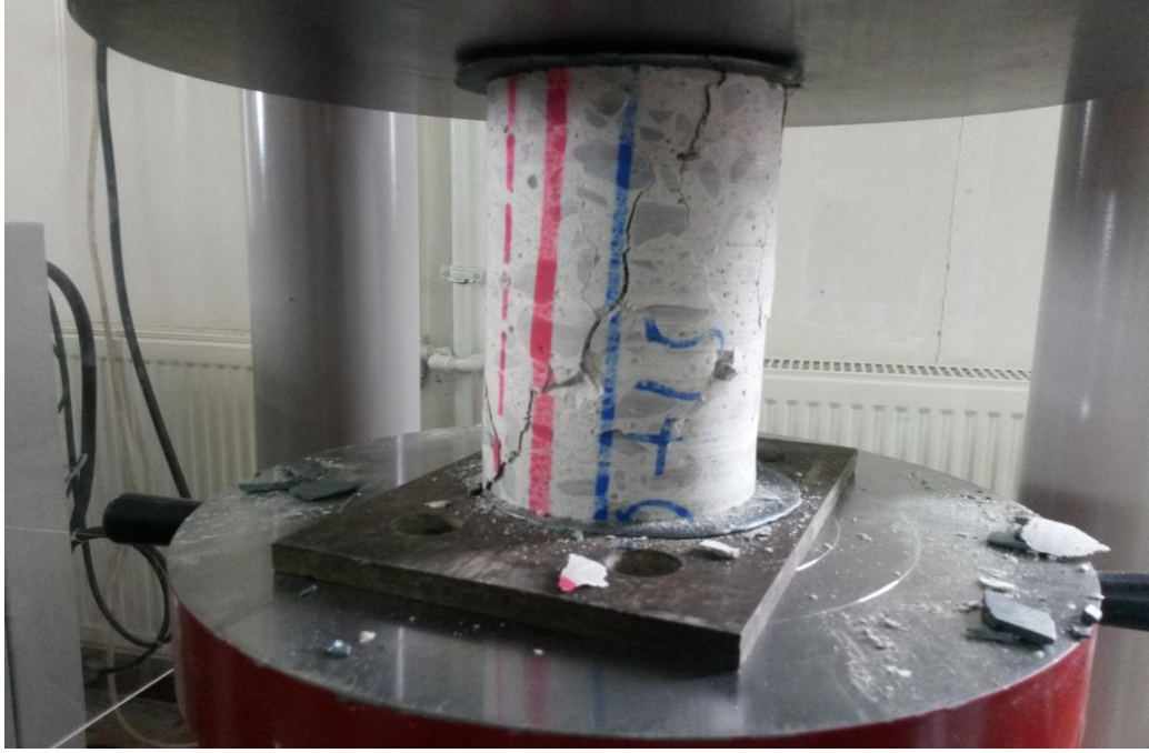
Şekil 4.16: Basınç testinde kırılmış karot numunesi
