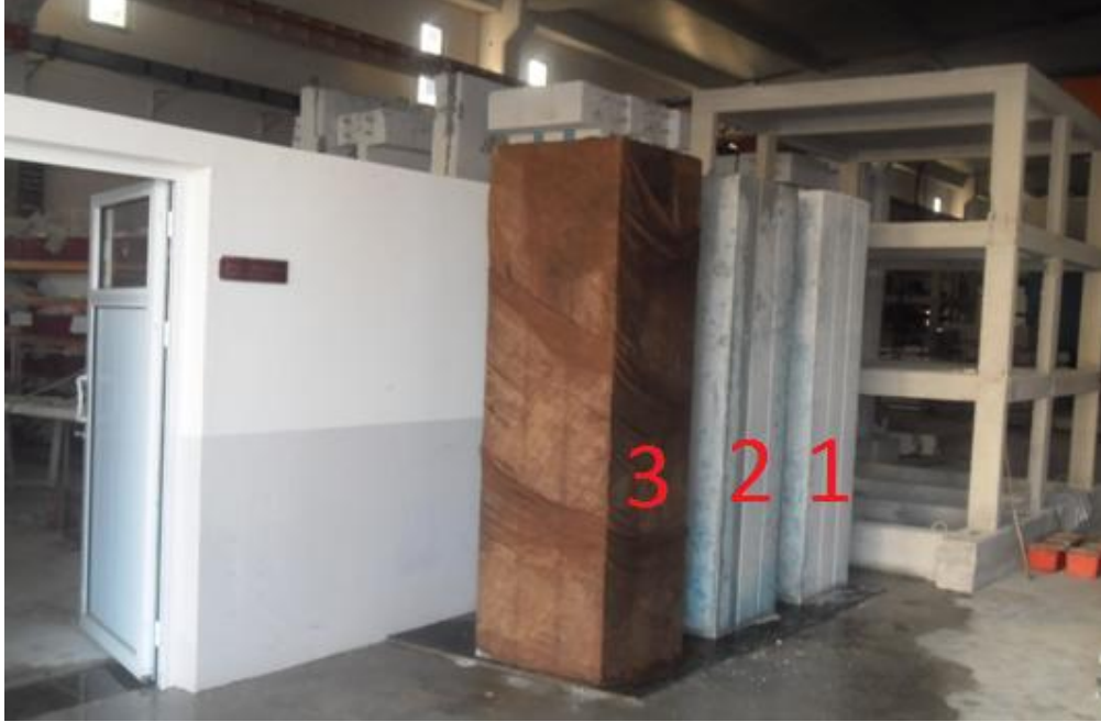
Şekil 3.3: Kolonların laboratuvar içinde kürlenmesi
