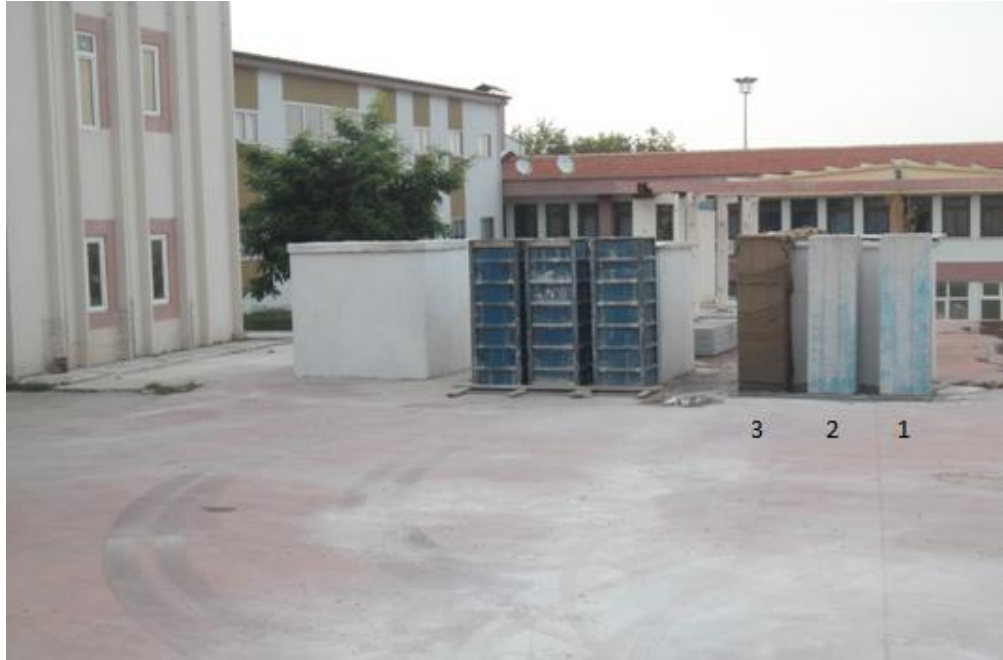
Şekil 3.2: Kolonların laboratuvar dışında kürlenmesi
