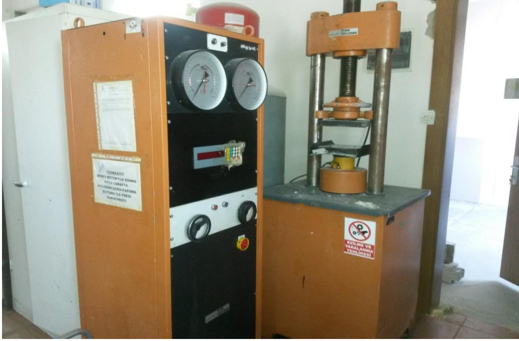
Şekil. 4.12: Çapları D54 ve D64 mm olan karotları test etmek için kullanılan Beton Basınç Dayanımı Test Makinası
