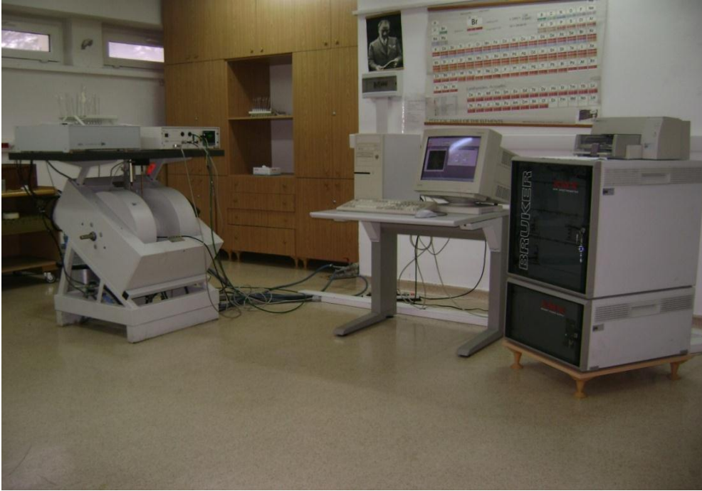
řekil 3.1. TAEK Sarayky laboratuvarındaki ESR spektrometresi
