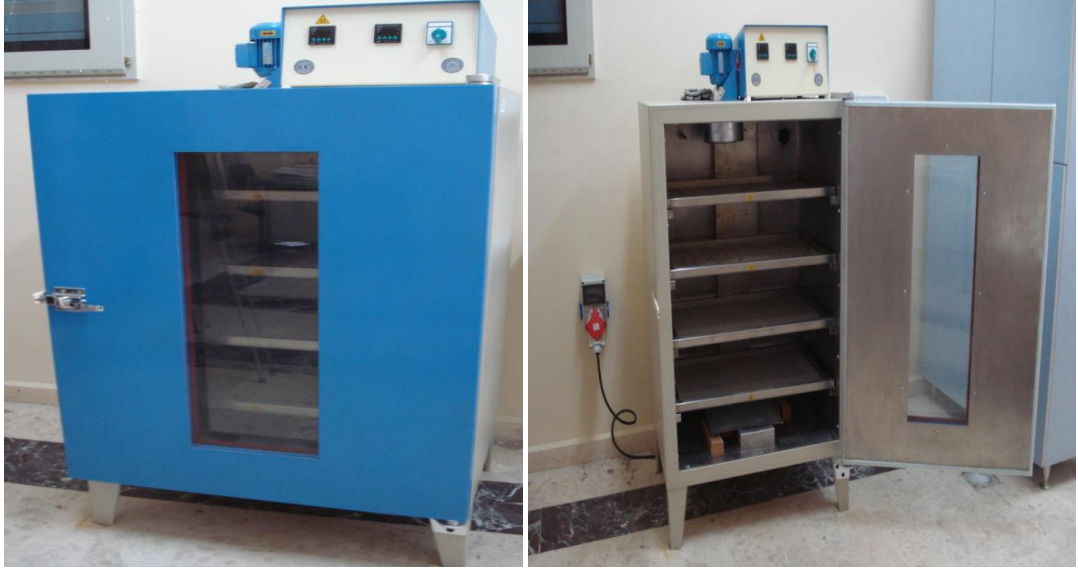
Şekil 2.4: Tepsili kabin kurutucunun genel görünümü
