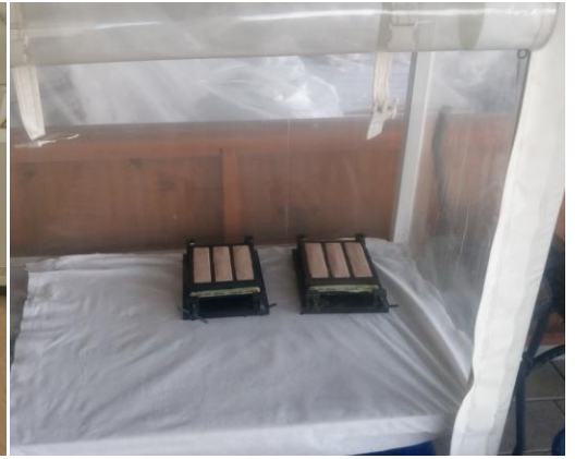
Figür 36: Onarım Harcının Kalıplara Dökülmüş Hali
