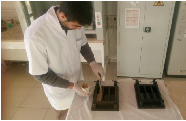
Figür 35: Onarım Harcının Kalıplara Dökülmesi
