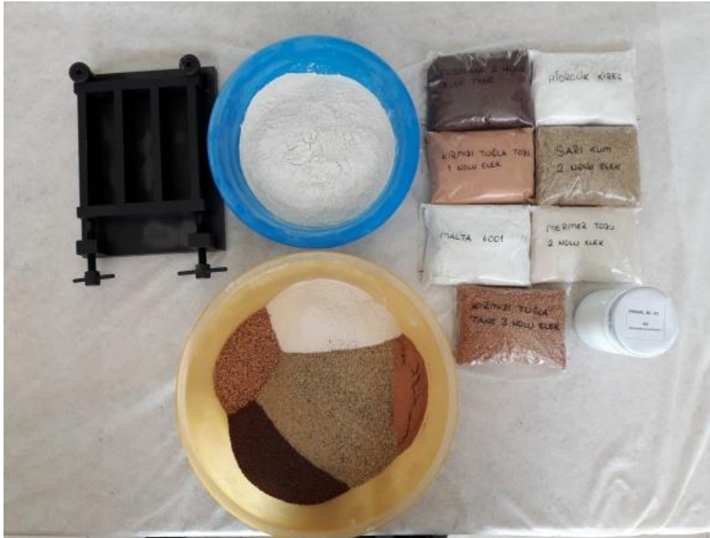
Figür 33: Onarım Harcında Kullanılan Malzemeler
