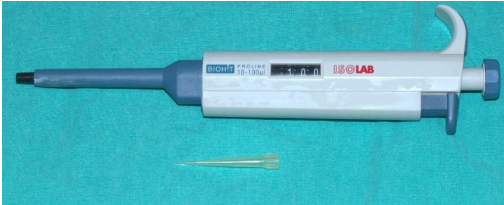
Şekil 3.10 ABL dozları, 100µl (0,1 ml) hacim ayarlı otomatik pipet ile ayarlandı.
