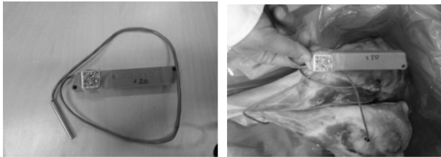
Şekil 5.12: RFID sıcaklık sensörleri, sensörlü sığır eti paketleri
